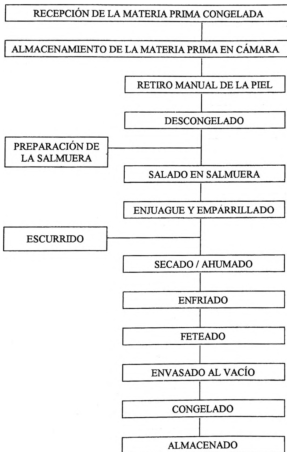
FIGURA 2. Flujograma del proceso para FILETE SIN PIEL de salmón ahumado en frío, feteado, congelado individualmente y envasado al vacío.
