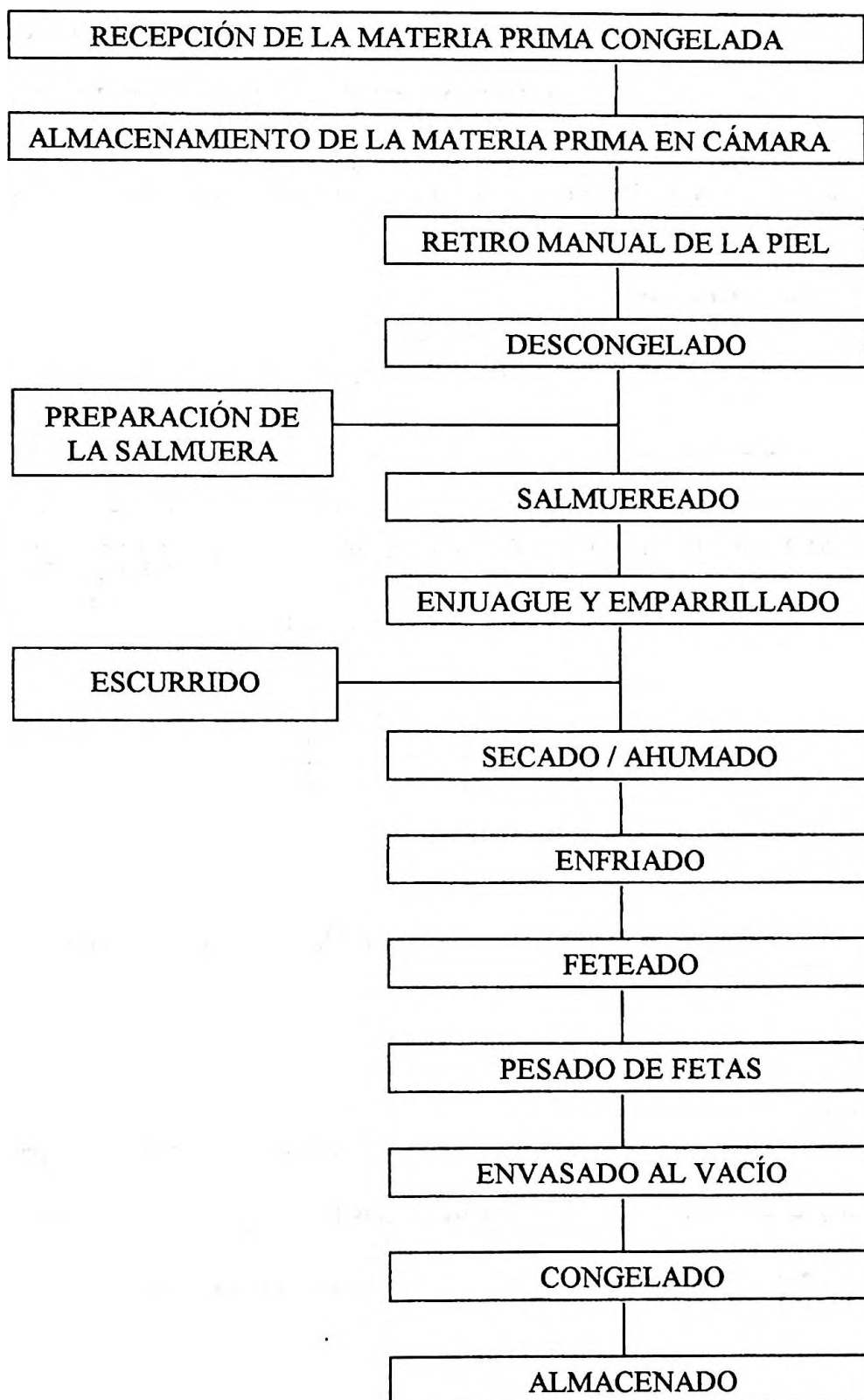
FIGURA 3. Flujograma del proceso para FETAS de salmón ahumado en frío, congelado y envasado al vacío en paquetes de 100 gramos.
