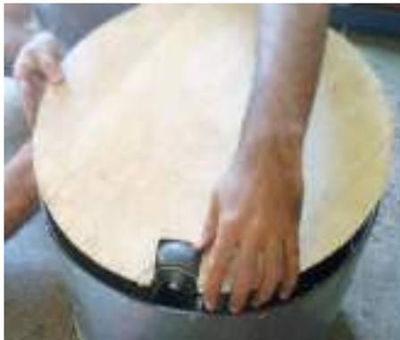
**5** Se colocó una superficie de madera y sobre ella un puente con poco contacto con la superficie y un fleje de acero apretado entre dos varillas metálicas, tensionadas con madera.
