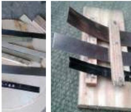
**4** Se probaron los distintos flejes de acero dentro de los módulos en diferentes tensiones, superficies y longitudes.
