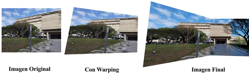
Figura 4.11: Ejemplo del proceso de *warping* plano en fotografía del edificio de Facultad de Ingeniería, UdelaR.
