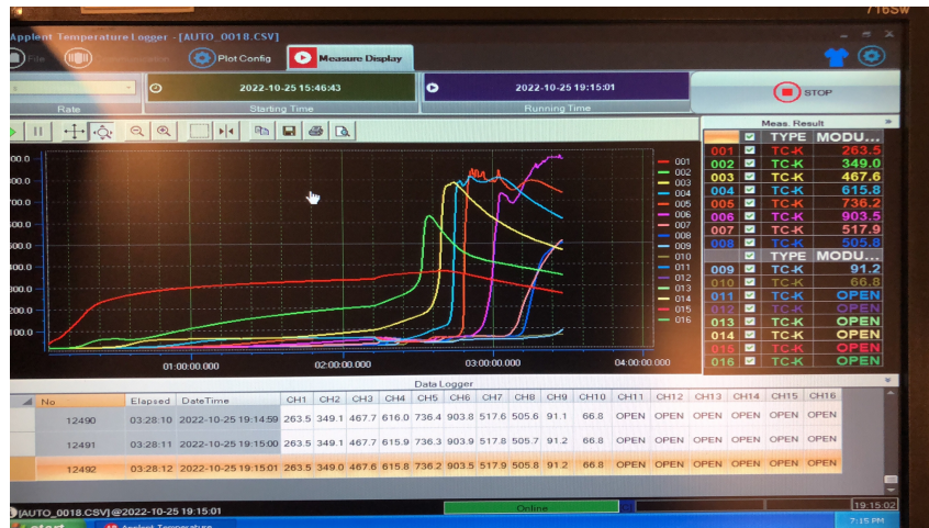
Figura 4.9: Registro gráfico de las termocupas en software.
