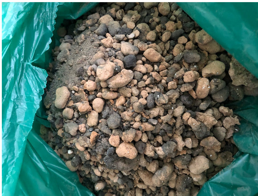
Figura 6.13: Restos de combustión quitados del reactor, luego de experiencia de smouldering.
