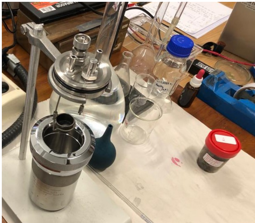
Figura 5.10: Bomba calorimétrica utilizada para el análisis.
