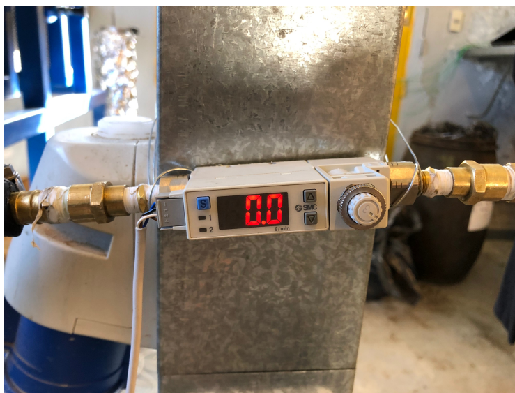
Figura 4.4: Controlador de flujo marca SMC modelo PFM750S.
