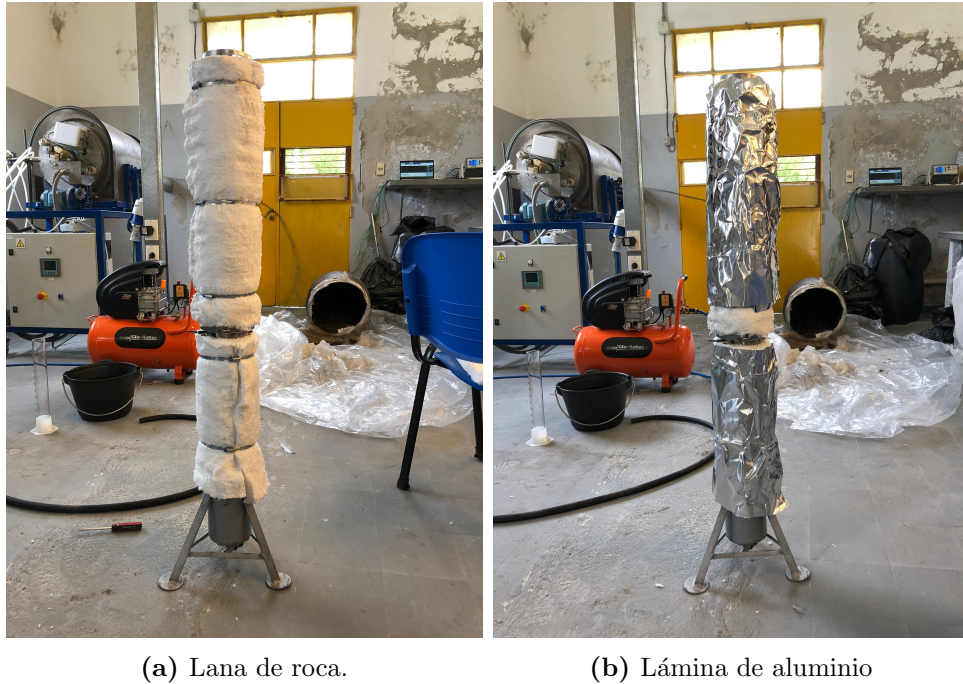
Figura 4.2: Cuerpo central de la reacción de smouldering, aislado en lana de roca y recubierto por lámina de aluminio
