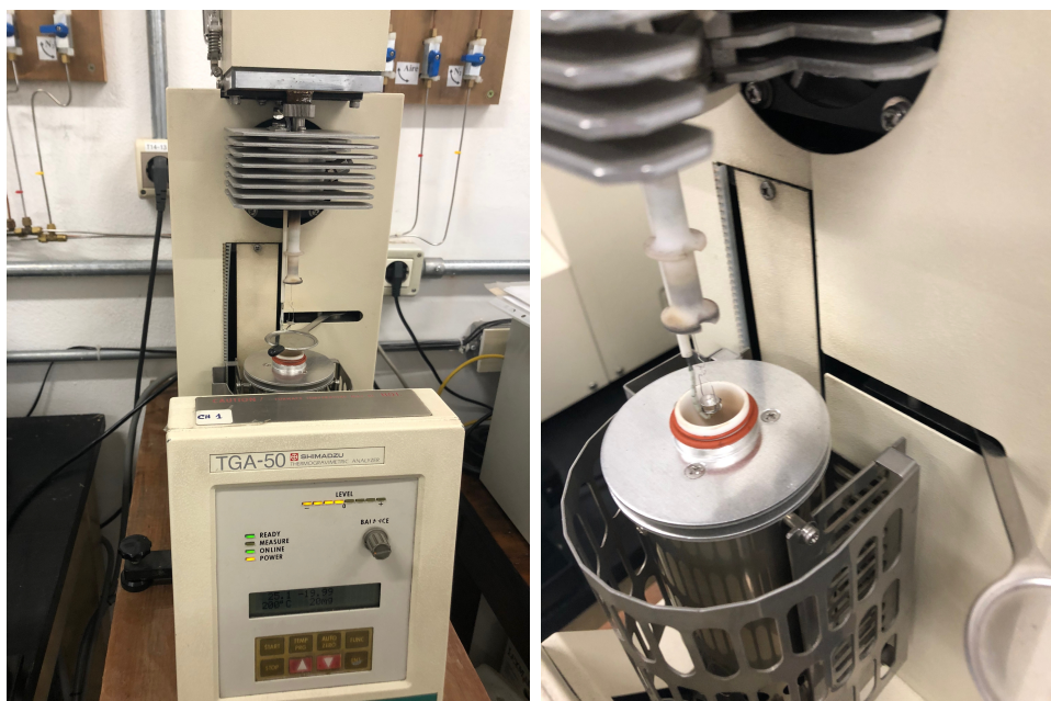
(a) Vista frontal del analizador TGA (b) Balanza de precisión del analizador
