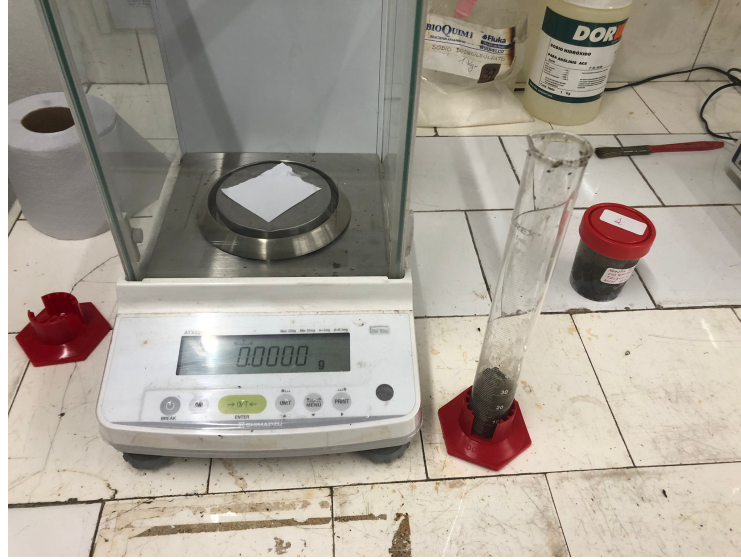
Figura 5.7: Bureta graduada con tierra contaminada, y balanza analítica utilizada para el cálculo de la densidad aparente.
