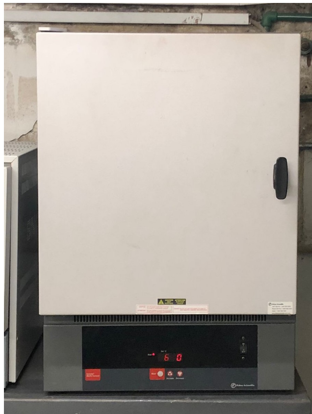
Figura 5.4: Mufla utilizada para el ensayo de determinación de volátiles.
