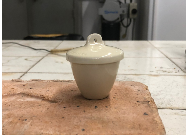
Figura 5.5: Cápsulas de porcelana utilizadas para realizar el ensayo de determinación de volátiles.
