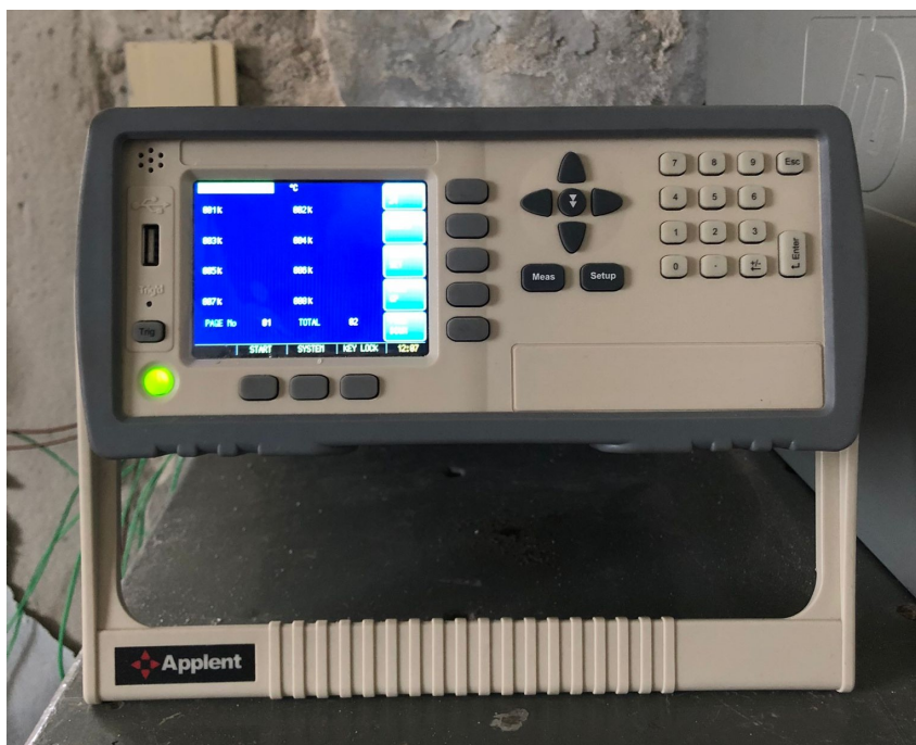
Figura 4.8: Datalogger marca Applent, modelo AT4516.
