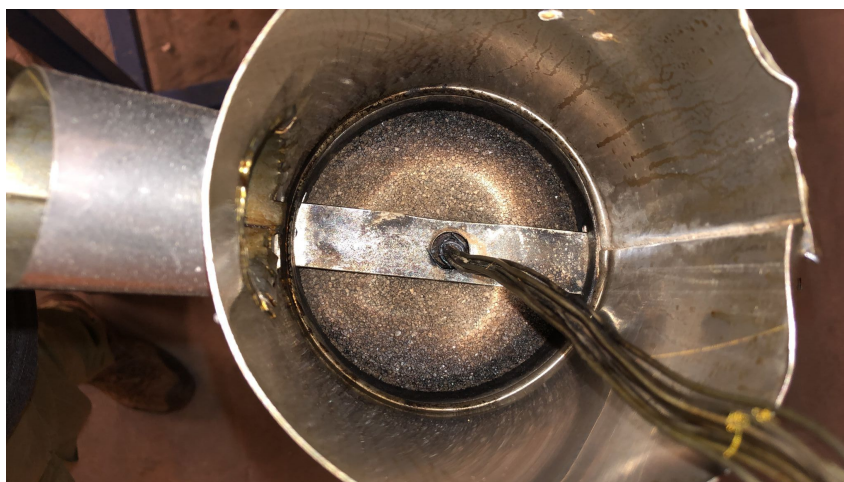
Figura 6.10: Superficie del reactor luego de finalizada la experiencia 3
