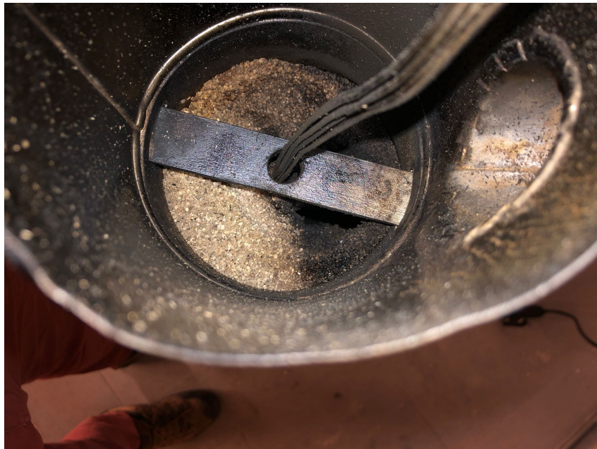
Figura 6.8: Hueco producido a causa del colapso de la mezcla en experiencia 2
