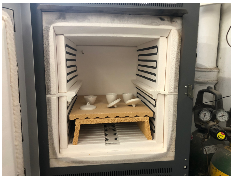
Figura 5.8: Cápsulas dentro de la mufla para ensayo de cenizas
