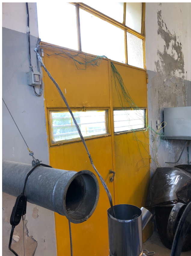
Figura 4.7: Manajo de termocuplas que sale del reactor hacia el datalogger.
