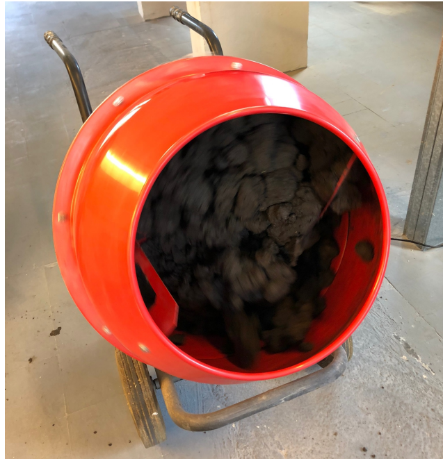
Figura 5.2: Mezcladora con tierra contaminada.
