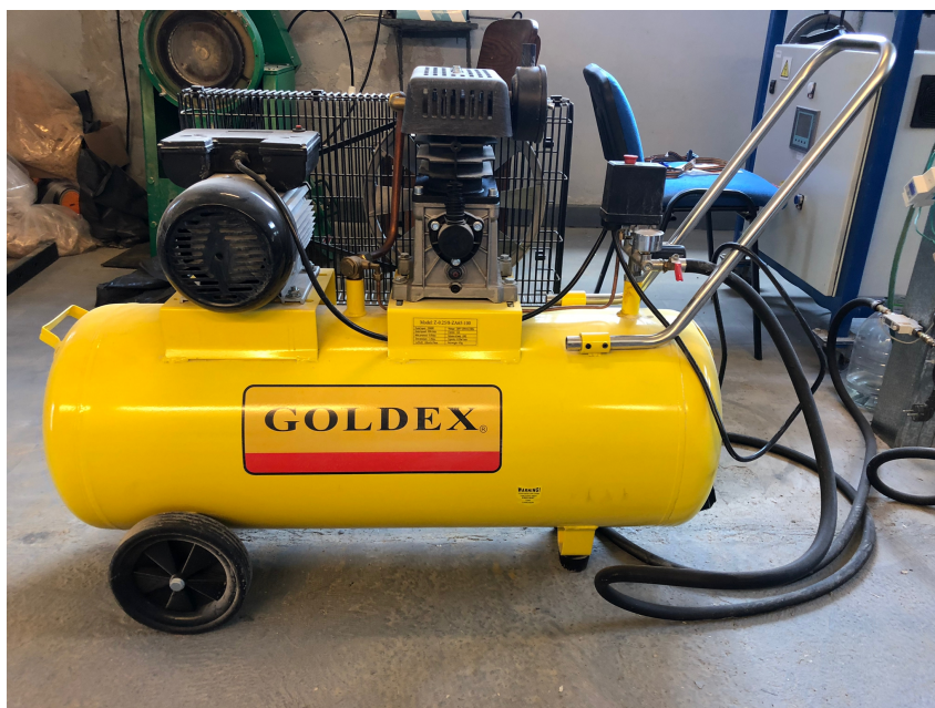
Figura 4.3: Compresor marca Goldex de 100 L de capacidad
