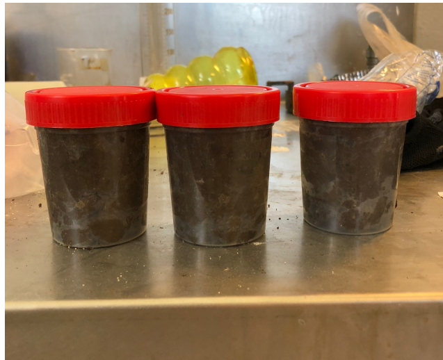
Figura 5.3: Frascos con muestras de tierra contaminada, donde se extraerá el material para los ensayos a realizar por triplicado.
