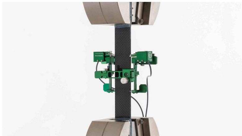
Figura 2.44: Galga extensométrica axial de uso general se utiliza en tracción o compresión (Fuente: Epsilon Technology Corporation).
