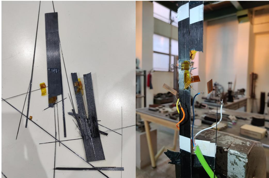
(a) Fractura total de probeta 1.
