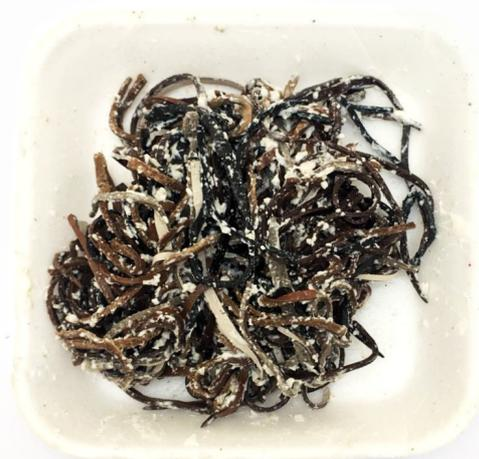
Fig 32. Mezcla con Sorbitol y aglomerante de Gelatina+glicerina+carbonato de calcio (imagen de elaboración propia).
