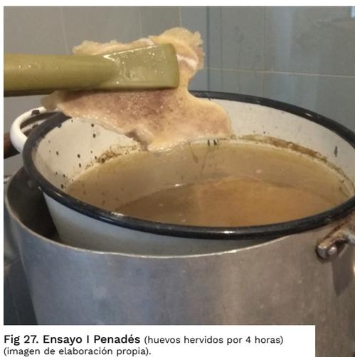
Fig 27. Ensayo I Penadés (huesos hervidos por 4 horas) (imagen de elaboración propia).
