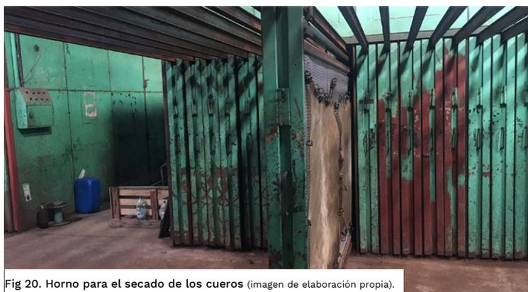
Fig 20. Horno para el secado de los cueros (imagen de elaboración propia).
