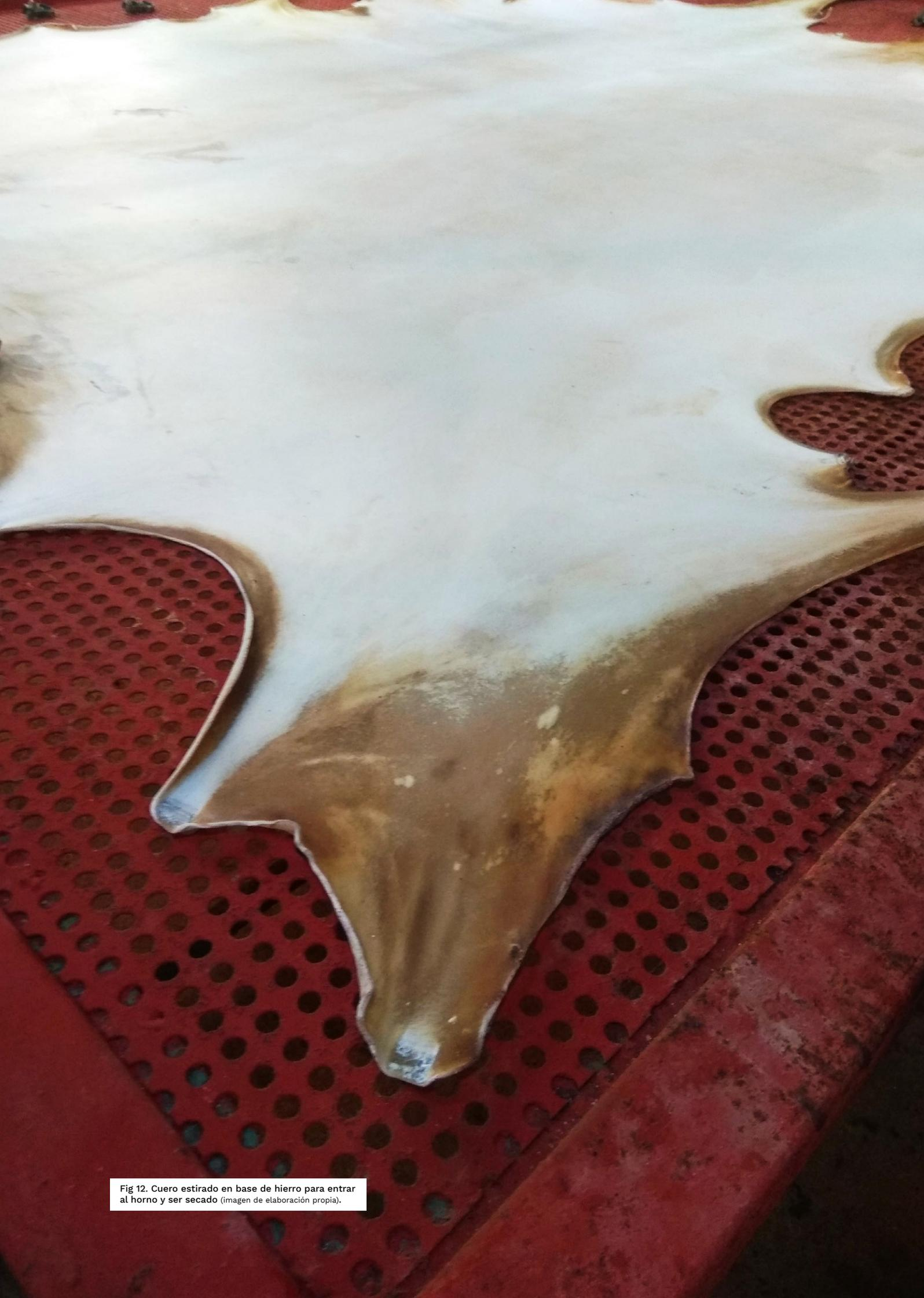
Fig 12. Cuero estirado en base de hierro para entrar al horno y ser secado (imagen de elaboración propia).
