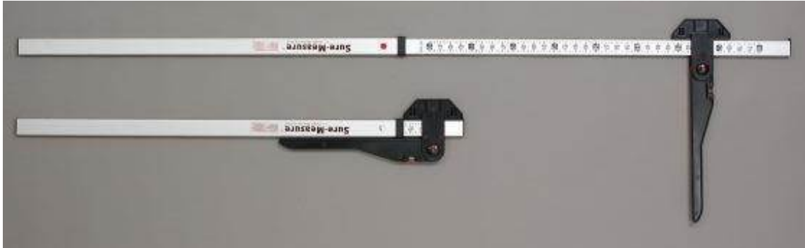
Figura 1. Instrumento utilizado para medir altura del anca (imagen ilustrativa), donde se puede apreciar el nivel (en color negro) y la regla milimetrada (en color gris)
