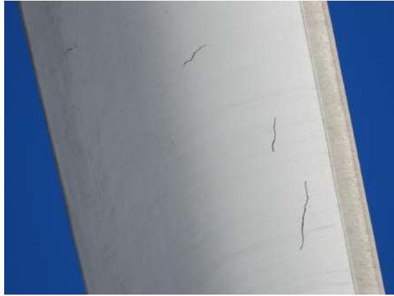
(a) Pala con cracks sintéticos.
