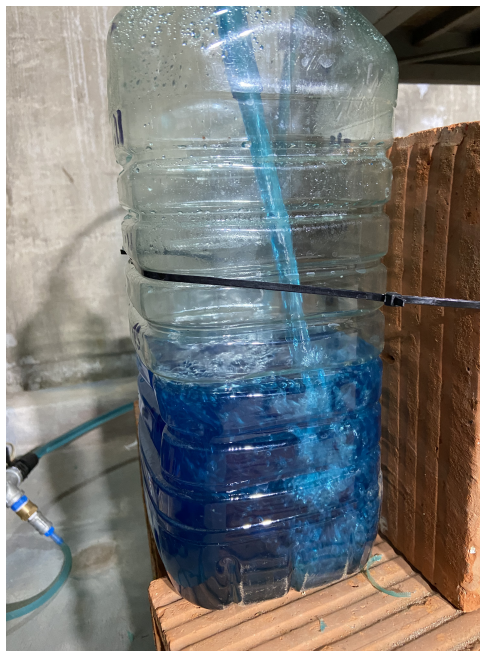
Figura 5.6: Tanque DrainBack con descarga directa de jet.
