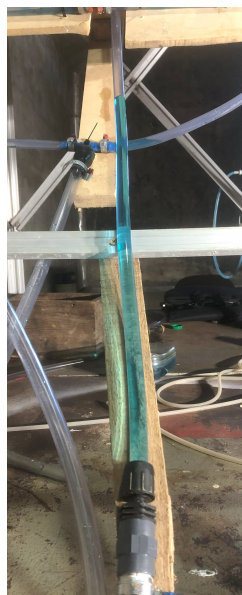
Figura 5.20: Columna de agua residual posterior al vaciado producto del uso de la válvula de regulación en la entrada al tanque DrainBack .
