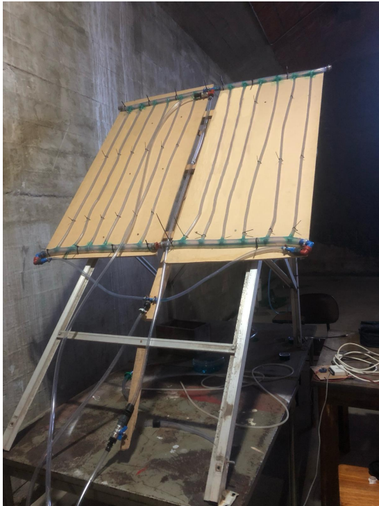
Figura 5.18: Solución propuesta para eliminar la columna residual.
