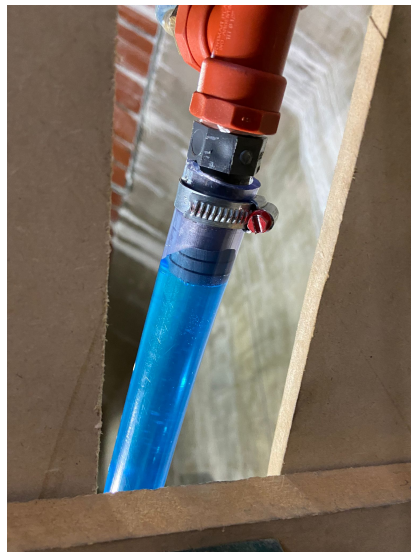
Figura 5.17: Pequeña burbuja de aire en formación de sifón 1" (salida de la toma de presión, visible en la Figura 5.4).
