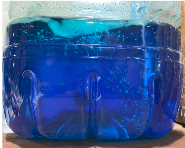
Figura 5.8: Entrada de burbujas al tanque DB .
