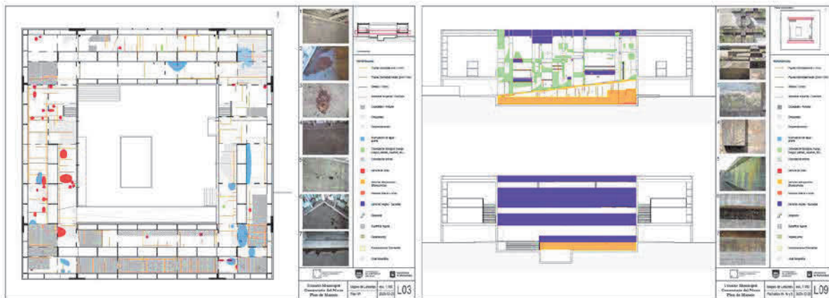
Figura 3: Mapeo de lesiones en plantas y fachadas
