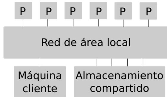
Figura 10: Diagrama simplificado de un clúster. (Figura basada en imagen extraída de Gebali [22].)
