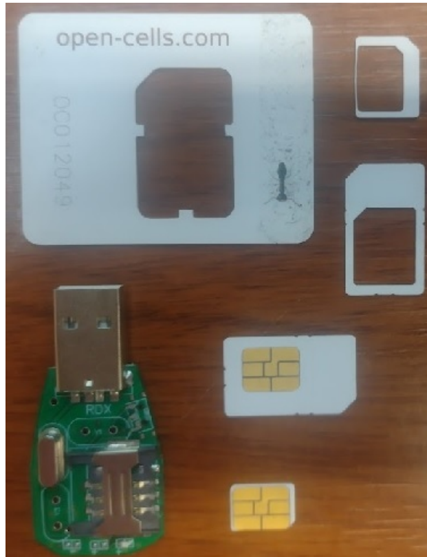
Figura 4.4: Las tarjetas SIM utilizadas en el proyecto, junto con la grabadora SIM USB.
