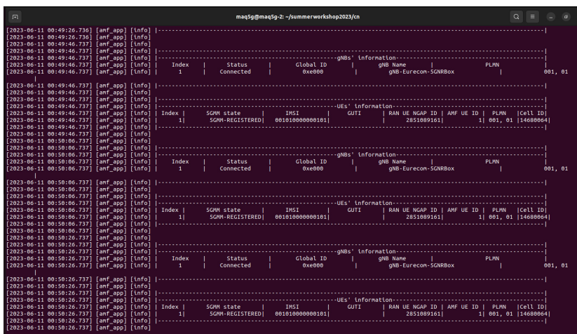
Figura 5.1: Logs del core AMF, donde se muestran el gNB conectado y el UE registrado.
