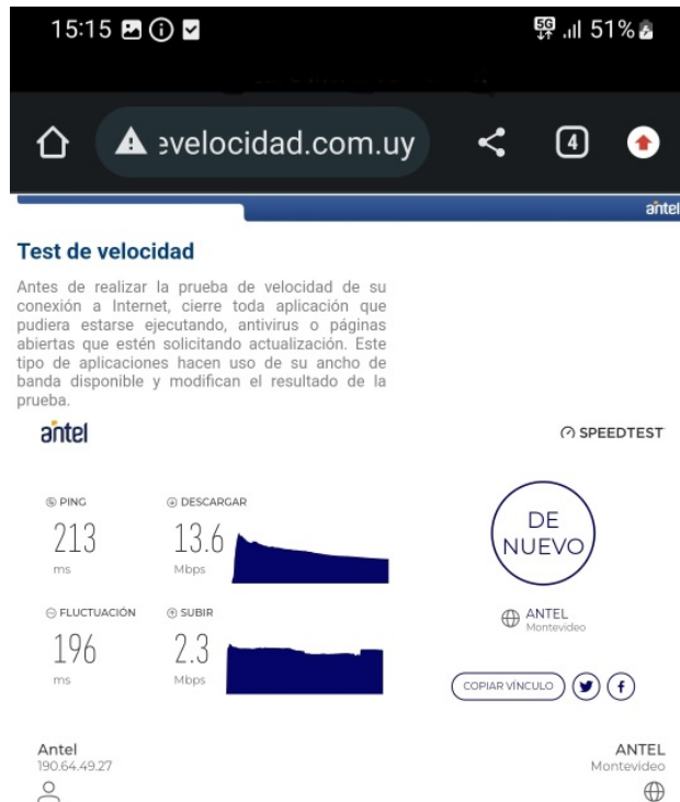
Figura 5.13: Speed test de internet, de móvil samsung A33 conectado al Core a través de SDR X310. El core esta conectado al internet libre de la Facultad de Ingeniería
