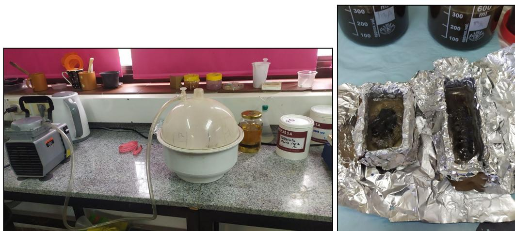
**Figura 3.17:** Procedimiento de impregnado con resina epoxi para la confección de láminas delgadas de las muestras de suelos, Laboratorio del Instituto de Ciencias Geológicas.
