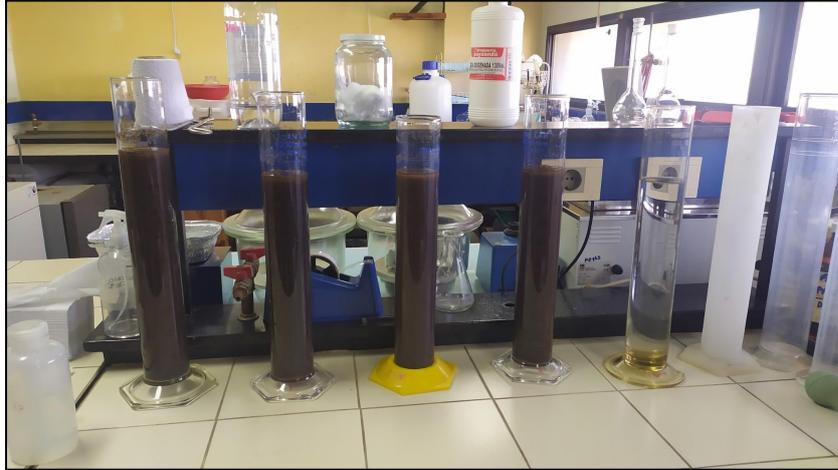
**Figura 3.16:** Probetas y muestras de suelo con dispersante antes del enrasado en el ensayo del hidrómetro Bouyoucos.
