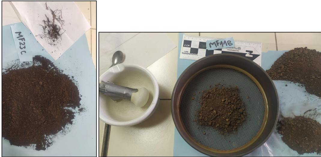
**Figura 3.14:** Preparación de muestras de suelo. *Izquierda:* Limpieza de muestra de suelo seca. *Derecha:* Tamizado de las muestras
