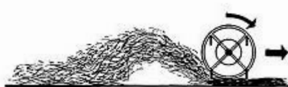
Fig. 2 - Giro en sentido contrario al avance. Dientes no sometidos a control.
