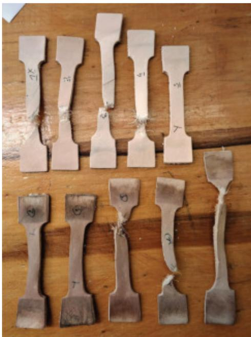
La celda utilizada para el ensayo es de 1000 Newtons (equivalente a 100 kg de fuerza máxima). La probeta nro. 5 en seco no llega a romper. Lo mismo sucede con las dos primeras probetas en húmedo, por lo que se decide sustituir la celda de 1 kN por una de 5 kN para las muestras restantes.
