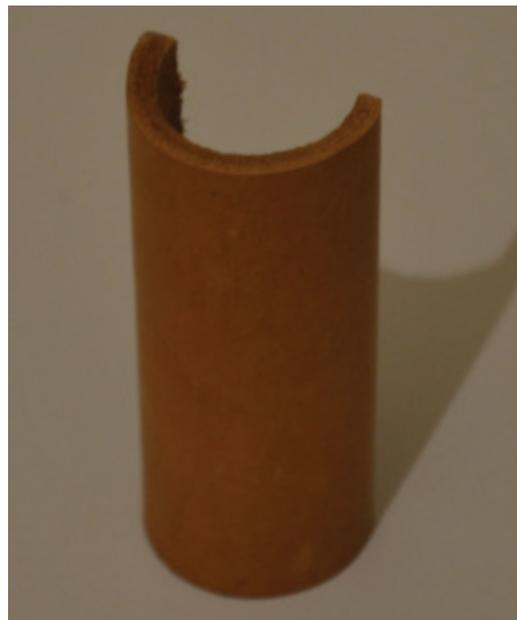
**Observaciones:** Es evidente la mejora en la toma de la forma, la cual se mantiene en el tiempo. La superficie del material queda totalmente lisa y brillante.
