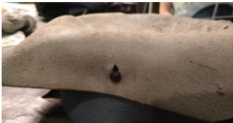
Posteriormente se sumerge el molde con el cuero ferrado a él en un balde con agua a poco más de 80 °C.
