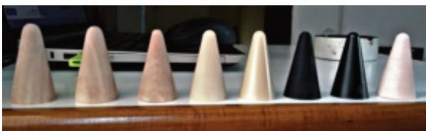
De izquierda a derecha: Las tres primeras en madera clara, las siguientes cuatro impresas con polyjet (rígido opaco, rígido brillo, cubierto en flexible opaco y cubierto en flexible brillo), la última impresa con FDM.
