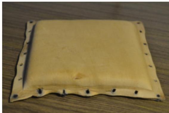
**Observaciones:** Se toma bastante bien la forma pero queda claro que cualquier defecto en el molde y el procedimiento de moldeado se transmite directamente a la pieza.
