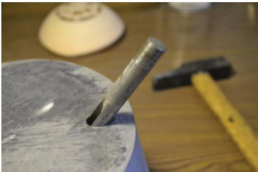
Sacabocado en posición dentro de uno de los canales guía del molde
