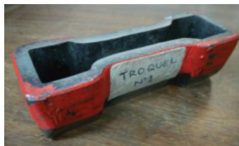
**Troquel para ensayos de tracción**
