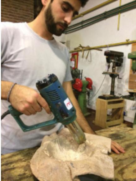
Proceso de secado con pistola de calor
