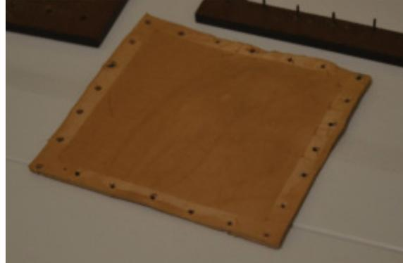
**Observaciones:** El cuero se moldea sin dificultad alguna y se calcula un aumento aprox de la superficie de un 4%. Al no generar la suficiente tensión y no contar con contramolde, el estiramiento es desparejo. Es muy difícil retirar el cuero del marco y se provocan deformaciones en el intento.
