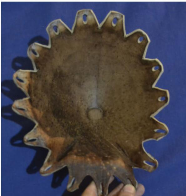
Se logra completar el proceso sin pliegues importantes. El cuero queda muy manchado por el agua caliente, más que en las pruebas anteriores.
