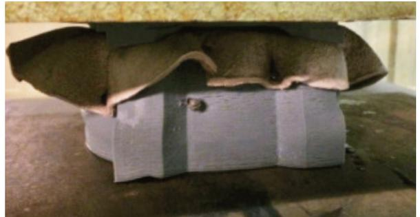
Deformación del molde durante el proceso de moldeo
