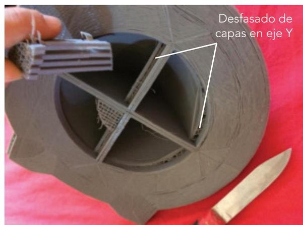
**Luego de impresa la pieza se retiran las estructuras de soporte y se lija suavemente**
