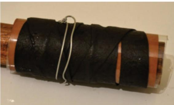
**Procedimiento:** En este caso se moja la pieza por inmersión durante 5 min y se sujeta rodeando el cilindro con goma y alambre. Se protege la superficie del cuero con acetato para evitar marcas. Se dejó secar por 24hs.
