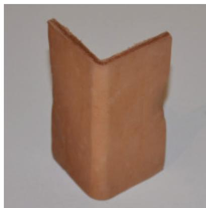
**Observaciones:** Se toma perfectamente la forma y se genera una pieza bastante firme. Al forzarla reiteradas veces se va perdiendo el ángulo generado. Las marcas del perfil quedan impresas en las superficie.
