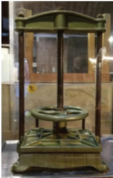
Se corta una pieza de cuero vaqueta acorde dejando un margen previendo posible rechupe de material y se procede al primer intento de moldeo. Al poco tiempo de comenzar a bajar la prensa se escuchan ruidos de resquebrajamiento y se detiene el proceso. El cambio provocado en la superficie de cuero es mínimo y se ve un daño en el molde debido a la fuerza aplicada y al rozamiento.
