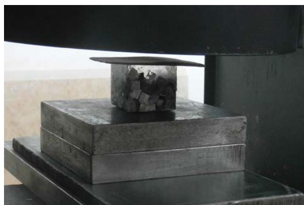
Figura 43. Ensayo de resistencia a la compresión a la muestra N° 14 - 6R*. Elaboración propia. (2018).
