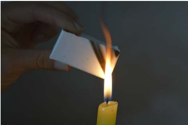
Figura 44. Ensayo de resistencia a la llama a la muestra N° 2 - 2R. Elaboración propia. (2018).
