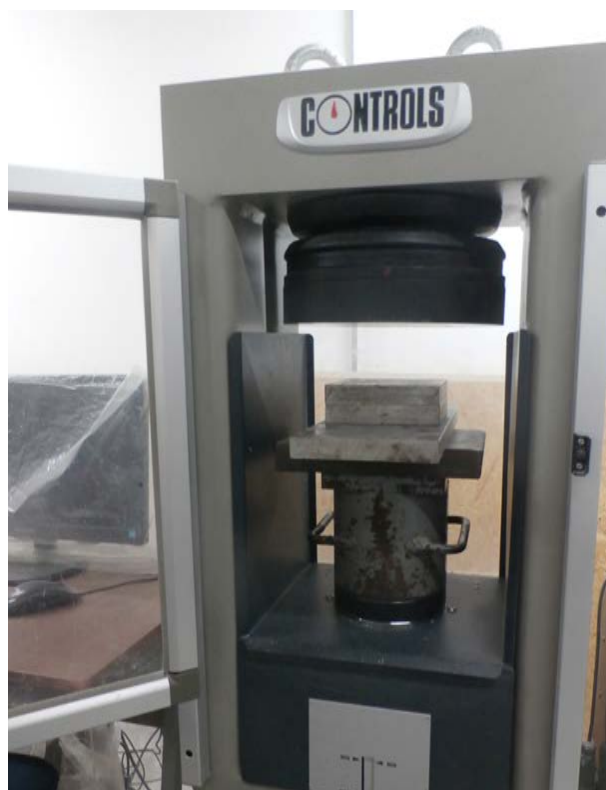
Figura 42. Máquina de compresión del Laboratorio del Instituto de la Construcción. Elaboración propia. (2018)
