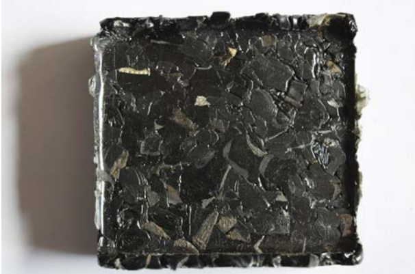
Figura 51. Muestra N°2 del ensayo de temperatura de fusión. Elaboración propia. (2018)
