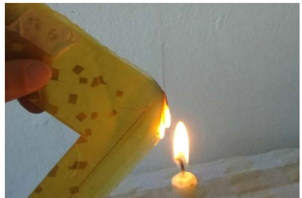
Figura 61. Ensayo de resistencia a la llama a una muestra. Elaboración propia. (2018)
