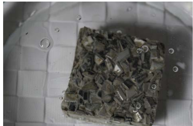
Figura 46. Ensayo de absorción a la muestra N° 7 - 7R. Elaboración propia. (2018)
