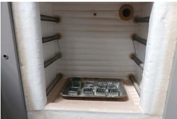
Figura 47. Proceso de secado en la estufa. Elaboración propia. (2018)
