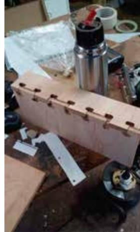
Mediante este tipo de encastre se quiere generar la unión de las caras del mueble sin utilizar tornillos, lo que dificulta esta idea es el no poder cortar en ángulo en el router CNC, este tipo de encastramientos tiene unos agujeros que servirían de vinculación entre caras de módulos, y por ellos pasaría una pieza pasante que uniría los dos módulos generando gran variedad de posibilidades de vinculación.
