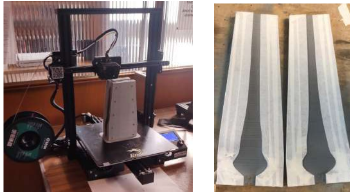
Figura 6.5: En la primera imagen se aprecia el molde en el proceso de impresión, en la segunda se puede observar el molde ya terminado
