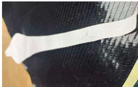
Figura 6.6: Recorte de la palas sobre fibra de carbono unidireccional
