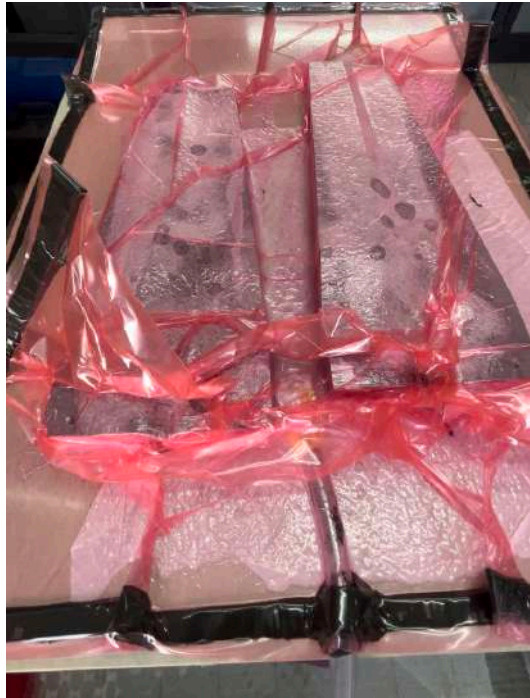
Figura 6.7: Molde con fibra de carbono adentro de las bolsa de vacío
