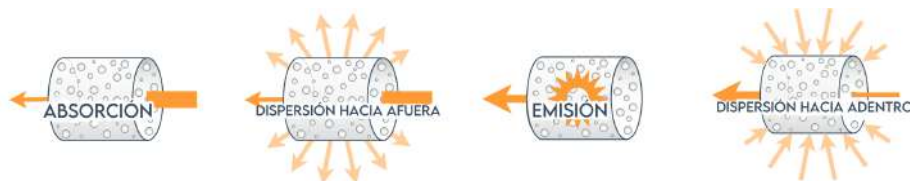
Figura 2.1: Interacciones de la luz en un medio participativo. La absorción y la dispersión hacia afuera reducen la radiancia, mientras que la emisión y la dispersión hacia adentro la incrementan.
