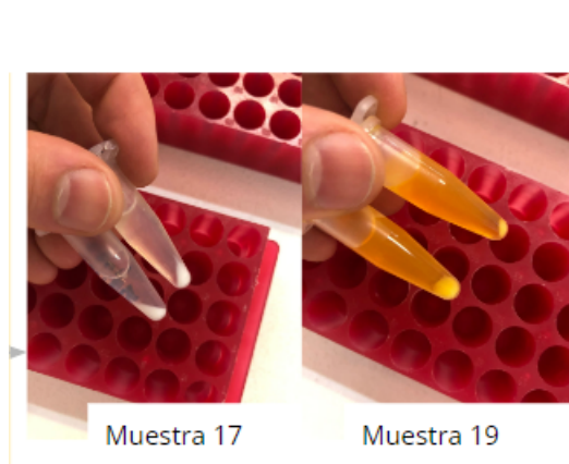
Figura 3.4: Resultados macroscópicos obtenidos en la precipitación de suero de esturión empleando sulfato de amonio 33 % de acuerdo con el protocolo de la metodología 4. A la izquierda se muestra resultado de precipitación derivado de muestra de suero de esturión n°17 (suero de partida de color blancuzco), a la derecha resultado de precipitación derivado de muestras de suero de esturión n°19 (suero de partida de coloración amarilla).
