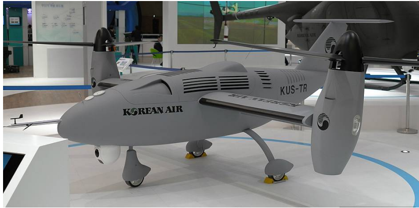
Figura 2.4: Dron KUS-TR de tipo VTOL (Yu, Heo, Jeong, y Kwon, 2016).
