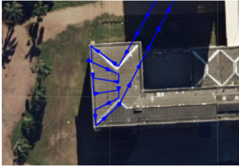
Figura 4.13: Planificación Local - Techo con forma de trapecio.
