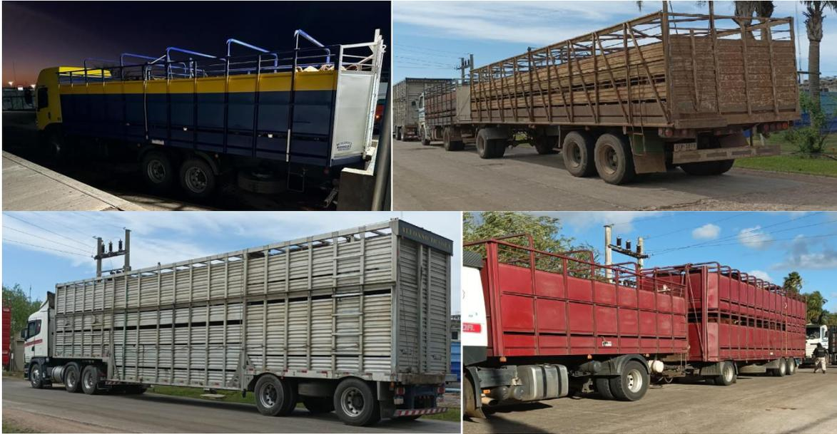
Figura 4. Tipos de camiones de transporte de animales en Uruguay. Arriba izquierda: camión simple; arriba derecha: camión remolque; abajo izquierda: camión doble piso; abajo derecha: camión mixto (Hernandez-Martinez, 2022).
