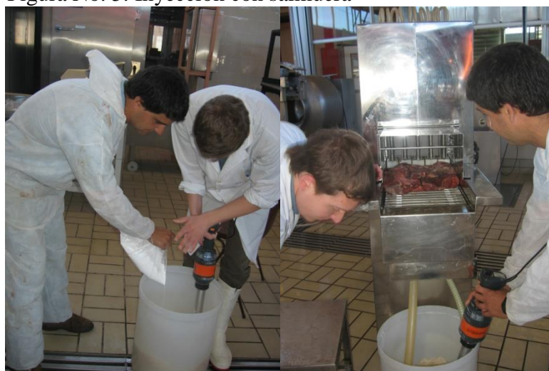
Figura No. 5. Inyección con salmuera
