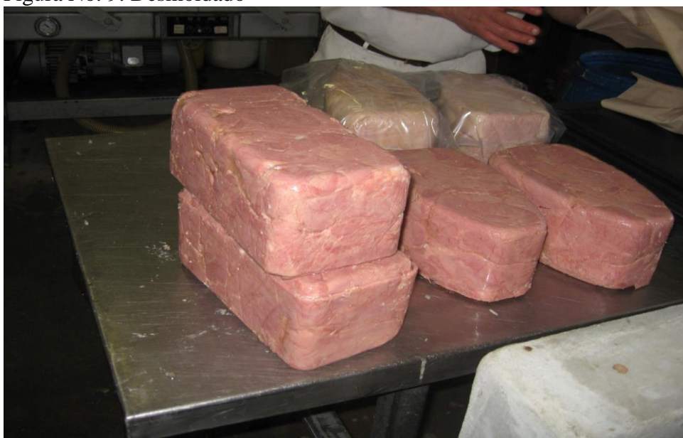
Figura No. 9. Desmoldado
