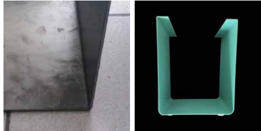
24. Der. Detalle pieza plegada con error en el radio.
