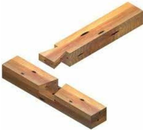
02. Encastre cola de milano (similar al utilizado en la silla). Antes de la producción es posible que el fabricante realizara pruebas del encastre para verificar la resistencia y su apariencia.
