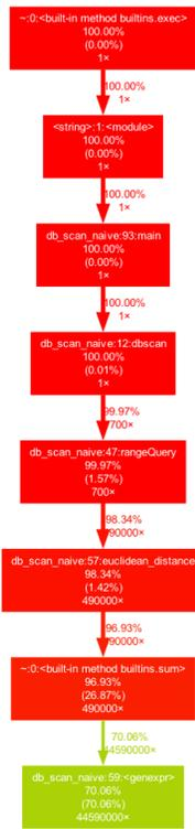
Figura 5.3: Visualización del resultado de la ejecución de un profiling sobre la ejecución del algoritmo DBSCAN “naive”.
