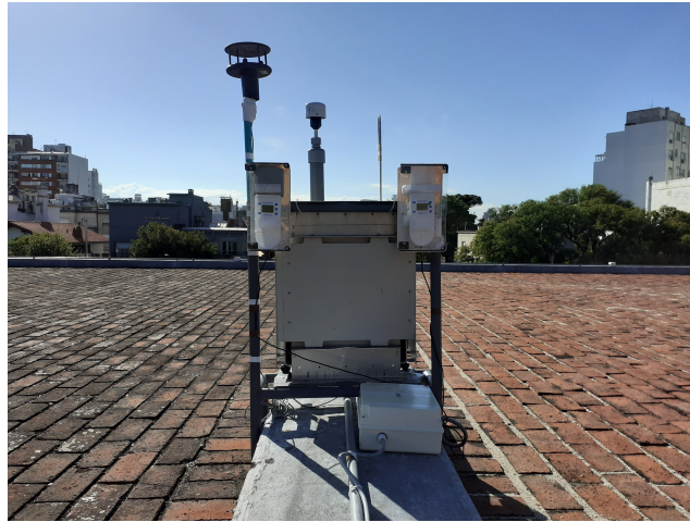
Figura 3.9: Ubicación del equipo Aeroqual AQM10, y medición simultánea con sensores portátiles. Fuente: proyecto Evaluación experimental de la exposición a contaminantes atmosféricos durante el transporte activo: aportes para su zonificación en Montevideo .
