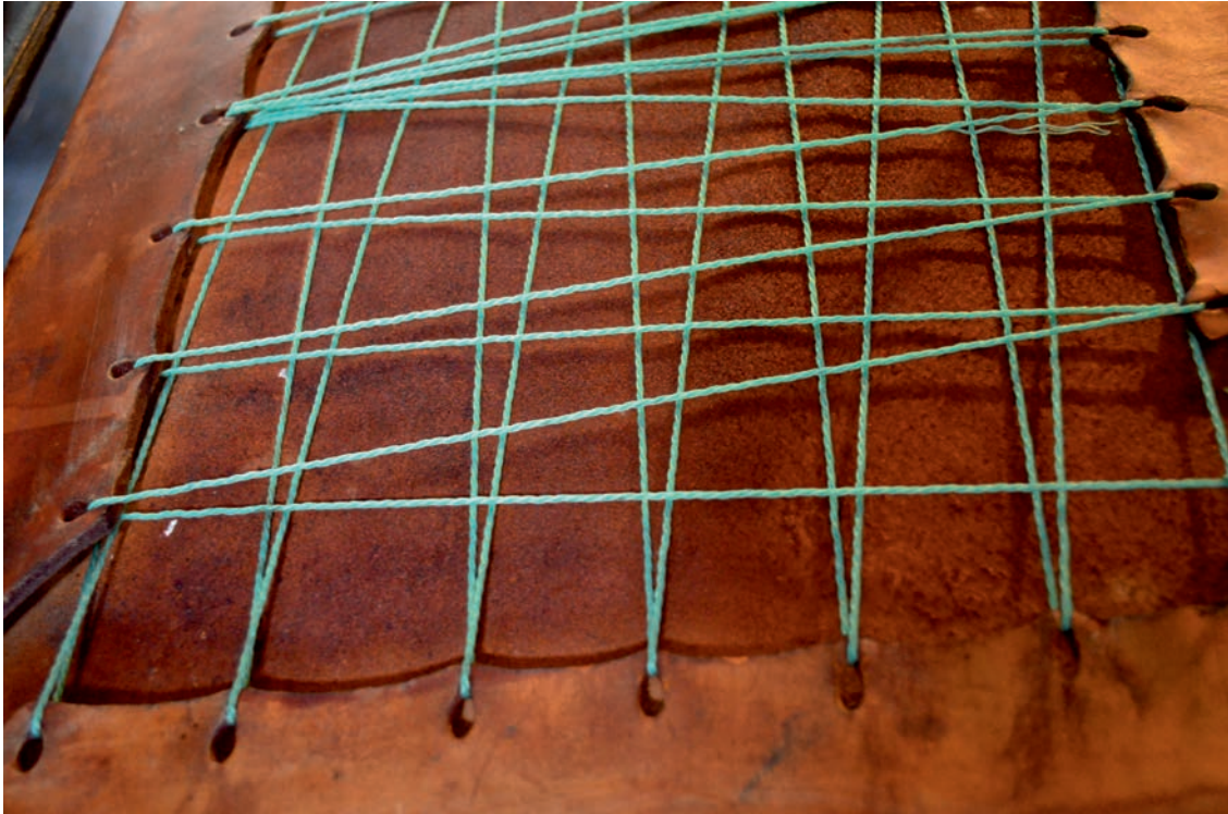
Detalle del tensado del cuero del asiento.
