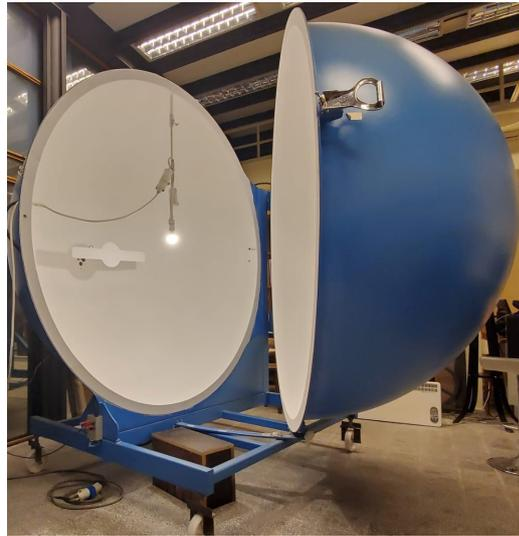
Figura 5.4: Esfera de Ulbricht utilizada.
