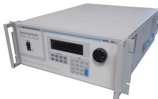
Figura 5.2: Fuente de tensión variable Ametek.
