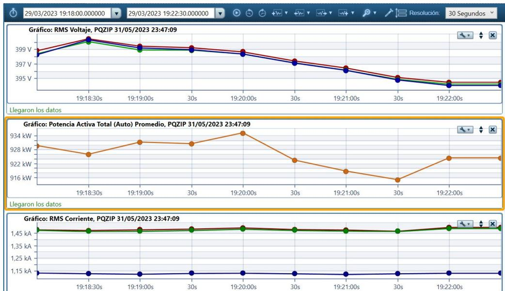
Figura 6.14: Caso 3 de caída de tensión provocada por la red.
