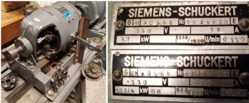
Figura 5.20: Generatriz dinamo-métrica Utilizada en ensayos de laboratorio.
