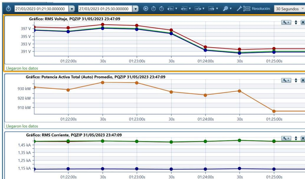
Figura 6.16: Caso 5 de caída de tensión provocada por la red.
