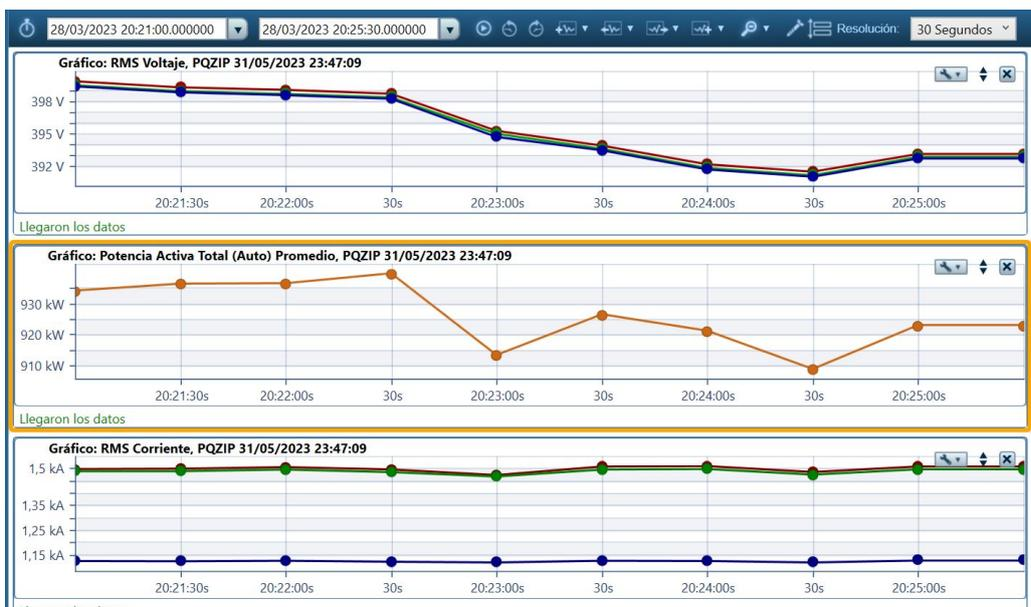
Figura 6.12: Caso 1 de caída de tensión provocada por la red.
