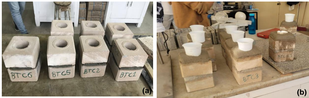
Figura 1 – Procedimientos previos al ensayo de compresión: (a) Bloques cortados superpuestos con mortero de junta; (b) Bloques con mortero de encabezado
