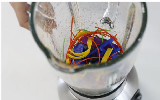
Fig 26: Nota. Trituración de piezas. Tomado de *Plastic Smoothie - DIY Plastic Recycling* (p.4), por Flowastik ,s.f, Instructables.
