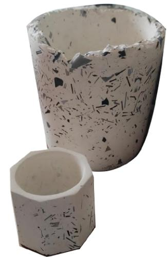
Fig 36: Nota. Maceta de concreto con plástico de impresión reciclado. Vega, Joaquin.
