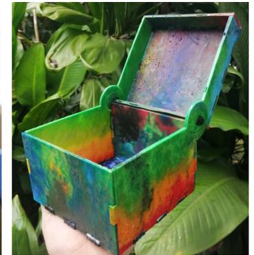
Fig 31: Nota. Caja reciclada a partir de plástico reciclado de impresión 3D. Tomado de Plastic Smoothie - Upcycled Plastic to Laser Cut Boxes (p.9),s.f. Instructables
