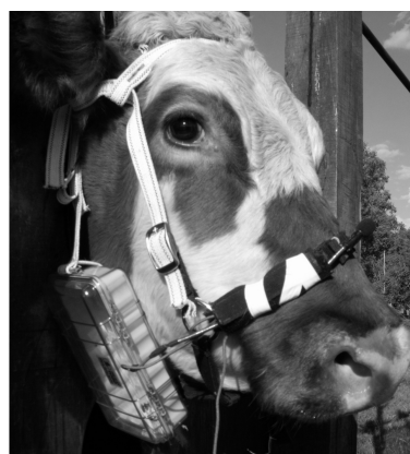
Figura 4. Bozal, caja con el dispositivo y micrófono.
