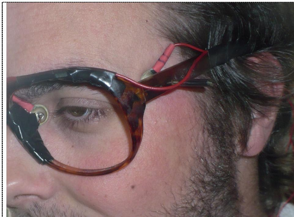
**Figura 2.** Los electrodos de **PANTOJO** en el armazón de lentes que lleva un voluntario sano. Notar la ubicación proyectada de la electrónica de amplificación detrás de la oreja.
