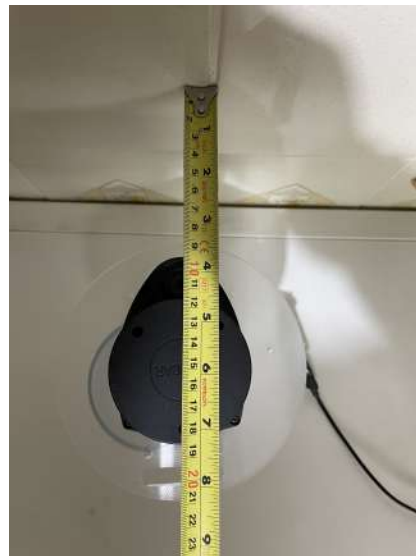
Figura 3.9: Disposición utilizada para tomar medidas con el LiDAR.
