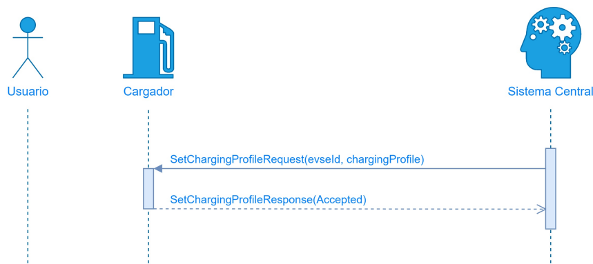
Figura 4.5: Diagrama de secuencia: SetChargingProfile
