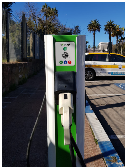
Figura 5.6: Cargador con identificador de tarjeta RFID. Equipo: Marca Ecotap, instalado en la inmediaciones del Zoológico de Montevideo.
