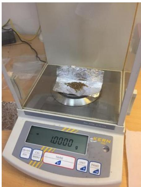
Figura No. 2. Balanza analítica (máx. 220g d=0.1 mg)
