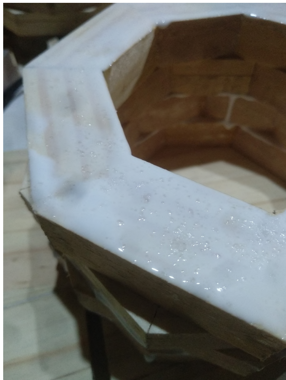
Durante la colocación de la cola y previo al prensado, se deja caer sal sobre la superficie para evitar desplazamientos indeseados al momento de prensar las piezas
