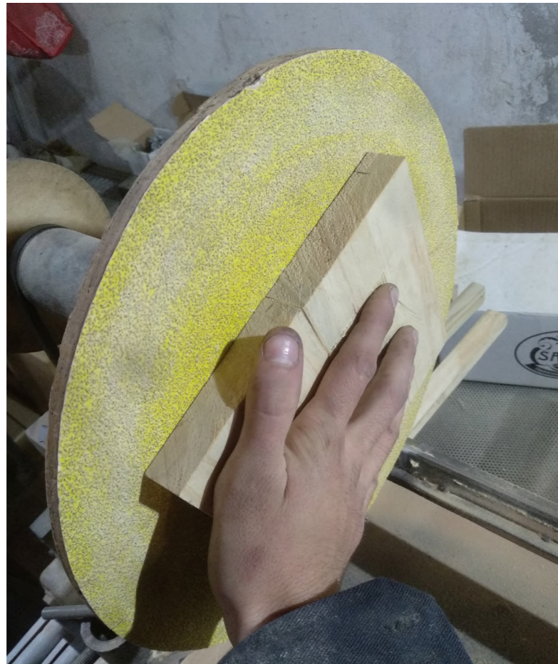
Lijado de tapas para generar buen contacto con el anillo
