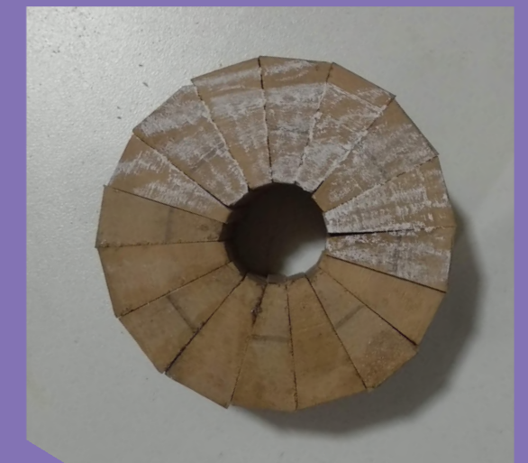
En las imágenes se aprecian dos detalles, se coloran las superficies con la misma lógica que las marcas de lápiz en el listón, mantener un registro de las caras del objeto para girarlo adecuadamente. Luego de lijadas las superficies de contacto, se invierte el sentido del semicírculo para anular el error de ángulo durante el lijado.
