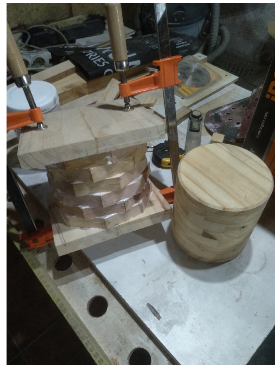
Encolado de los anillos y tapas.
