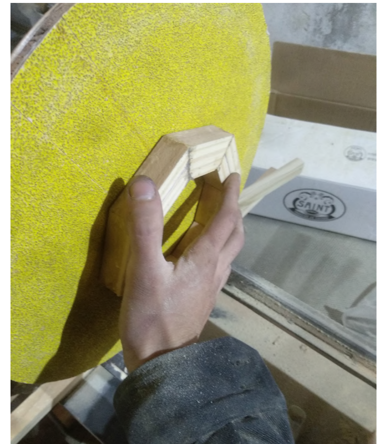
Lijado de los anillos completos para su posterior encolado grupal
