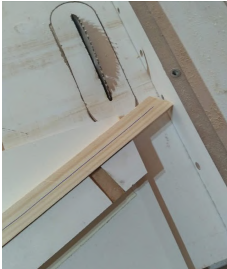
Se traza una línea en una de las superficies del listón para mantener el seguimiento de las piezas
