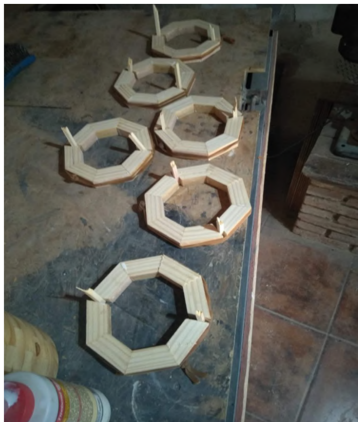
Se traza una línea en una de las superficies del listón para mantener el seguimiento de las piezas
