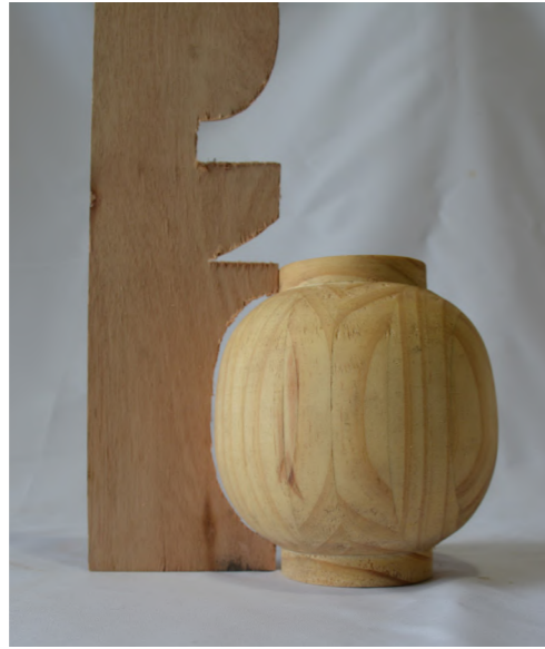
Se generó una plantilla para copiar en ambas piezas la forma buscada.
