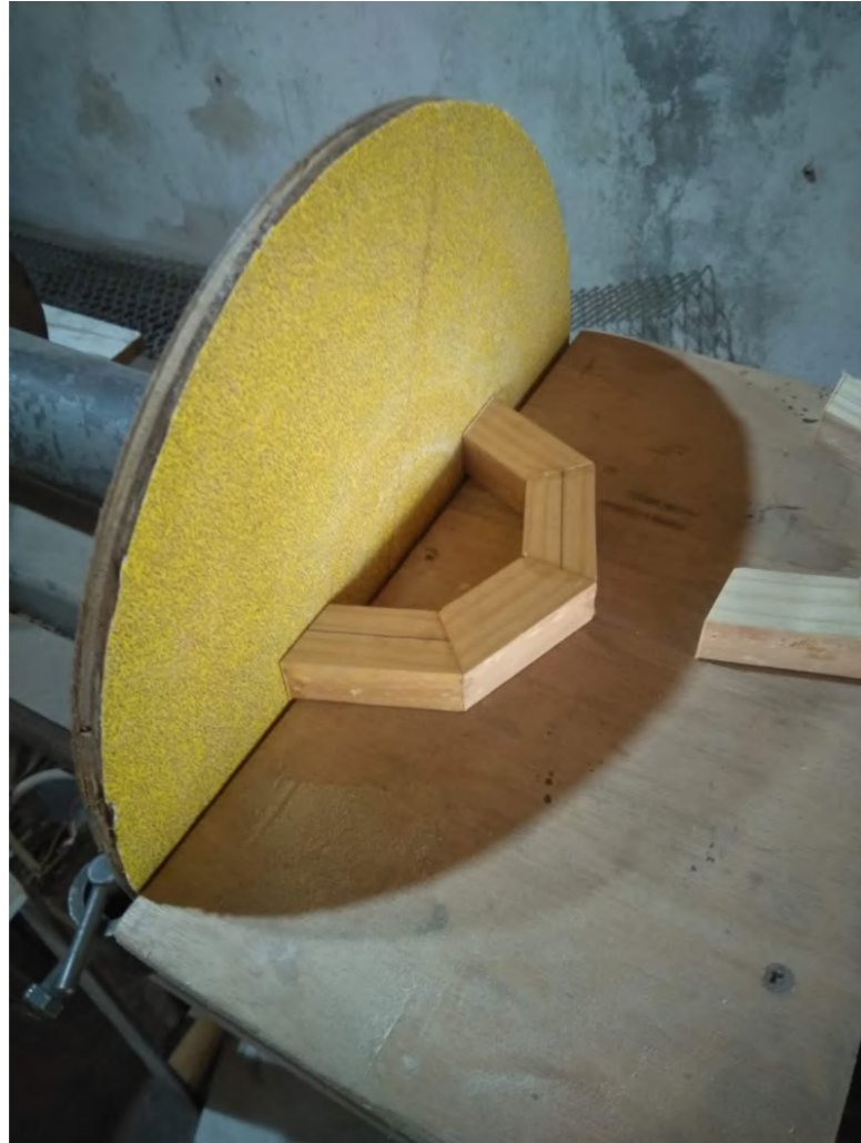
Encolado de los semicírculos para luego ser lijados
