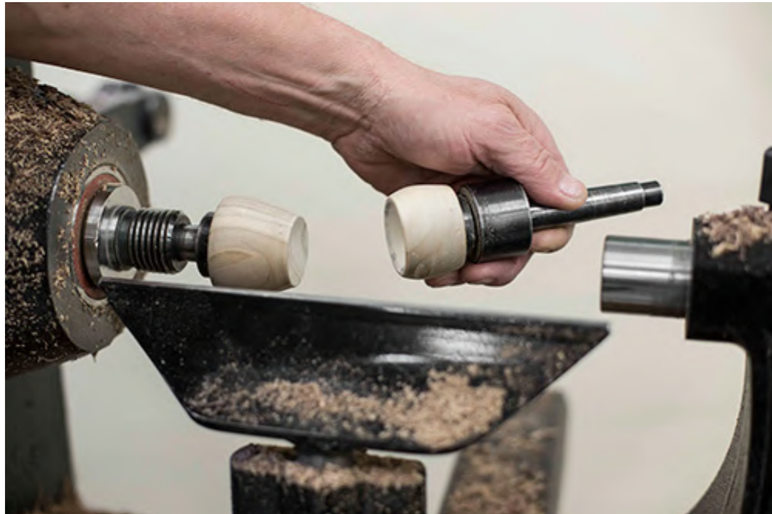
Copas para el torneado de esferas, estas se colocan en la punta y contrapunta y se aplica presión para generar el rosamiento suficiente para trabajar. Fotografía: WoodWorkers Journal
