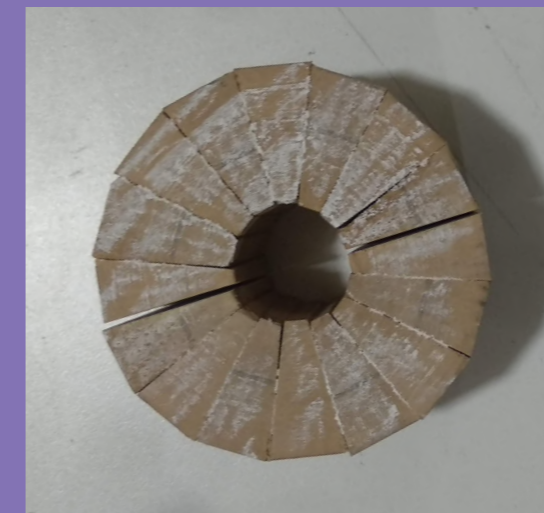
En las imágenes se aprecian dos detalles, se coloran las superficies con la misma lógica que las marcas de lápiz en el listón, mantener un registro de las caras del objeto para girarlo adecuadamente. Luego de lijadas las superficies de contacto, se invierte el sentido del semicírculo para anular el error de ángulo durante el lijado.
