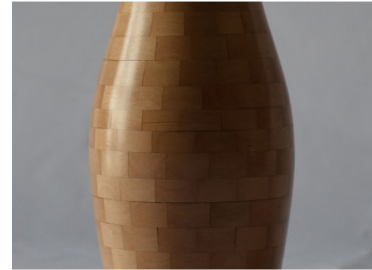
Se puede ver una línea negra entre grupos de anillos, esto es debido a la falta de coplanaridad entre ellos. Se podría atribuir a una falta de presión al momento del encolado pero el detalle solo se aprecia en sectores de la unión y no en todo el perímetro.
