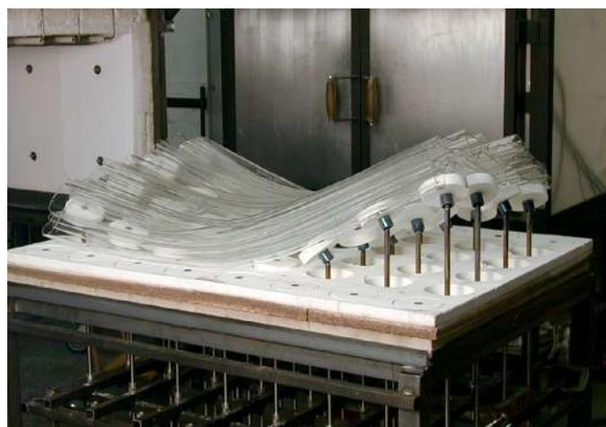
Figura 20. Weinstein, N. (2015) Prueba de concepto de lecho dinámico de moldeado pequeño de prueba. Recuperado de: <https://nikolas.net/node/300>
