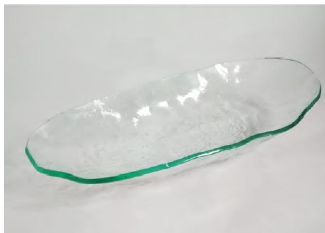
Figura 50. Vidrio termomodelado sobre molde con modificación 4
