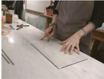
Cortar el vidrio con la forma base deseada para el termomodelado
