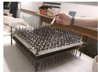
Colocar el desmoldante o interpolador en los puntos de apoyo
