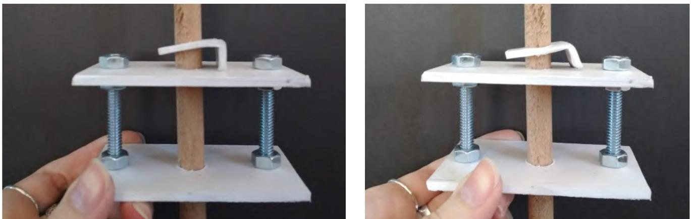
Figura 34. Maquetas escala 1:4 del sistema de bloqueo de varillas individuales con variante de la altura del bloqueador
