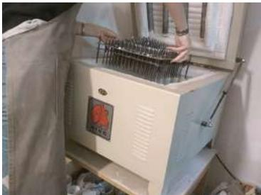
Colocar el molde dentro del horno sobre la base de acero inoxidable
