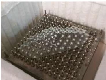
Al llegar el horno a temperatura ambiente nuevamente, desmoldar la pieza
