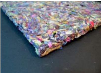
Figura #22. Panel de absorción acústica. Recuperado del Trabajo de Grado
