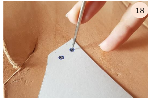
Figuras #17 y #18 Marcado de un molde en el cuero. Elaboración propia.
