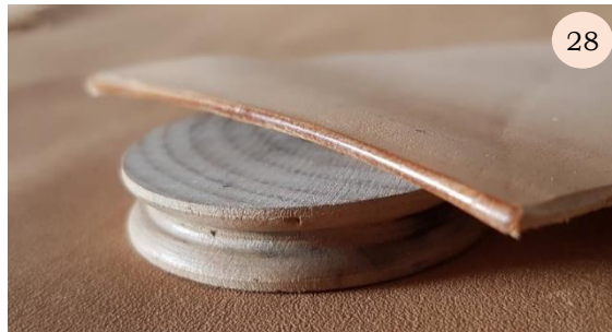
Figuras #27 y #28. Pulido de bordes con agua. Elaboración propia.
