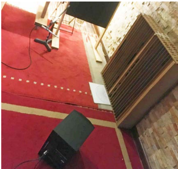
Figuras 2.9. Disposición de los elementos en la sala de grabación para el segundo ensayo. El semicírculo permite modificar la posición del micrófono receptor, de manera de controlar los grados a los que se encuentra, siempre a una distancia fija del difusor de 85 cm. El parlante no varía de posición y se encuentra también a 85 cm
