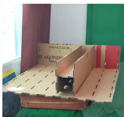
Figura 2.5. Construcción en cartón de los difusores. Cuentan con una base, una tapa de arriba y una tapa posterior. Luego las aletas (todas iguales) que definen cada ranura o celda, y su correspondiente tapa (varían la posición acorde a los cálculos realizados por el software QRDude
