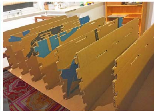
Figura 2.5. Construcción en cartón de los difusores. Cuentan con una base, una tapa de arriba y una tapa posterior. Luego las aletas (todas iguales) que definen cada ranura o celda, y su correspondiente tapa (varían la posición acorde a los cálculos realizados por el software QRDude
