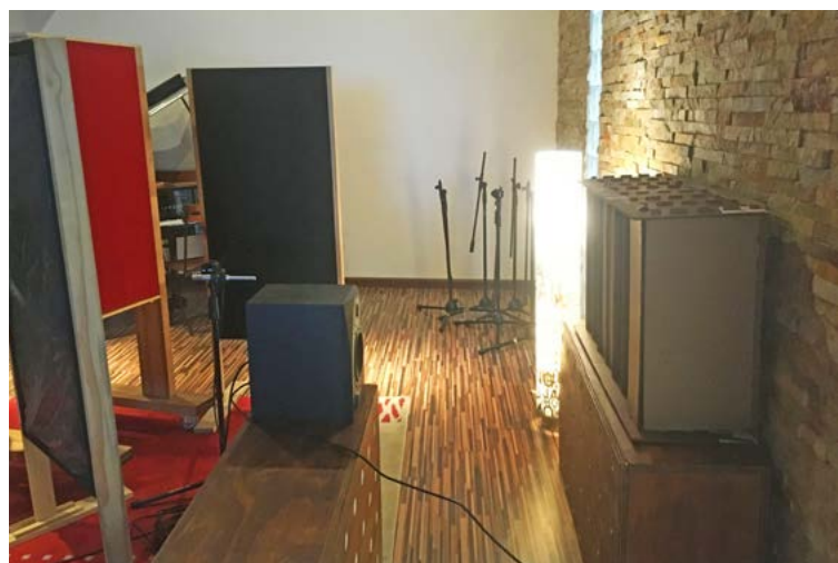
Figuras 2.7. Estudio de grabación con los materiales dispuestos para realizar la primera prueba. Difusor QRD 400 Hz dispuesto contra la pared a la altura de los paneles absorbentes. Por frente, a la misma altura, se encuentra el parlante que va a reproducir el sonido y un poco por detrás el micrófono que toma el sonido que rebota en el difusor. Por detrás de todos estos elementos se encuentran los paneles absorbentes que buscan eliminar sonidos ambientes que puedan intervenir en el sonido que reciba el micrófono, así como las alfombras en el suelo generan mayor absorción del sonido
