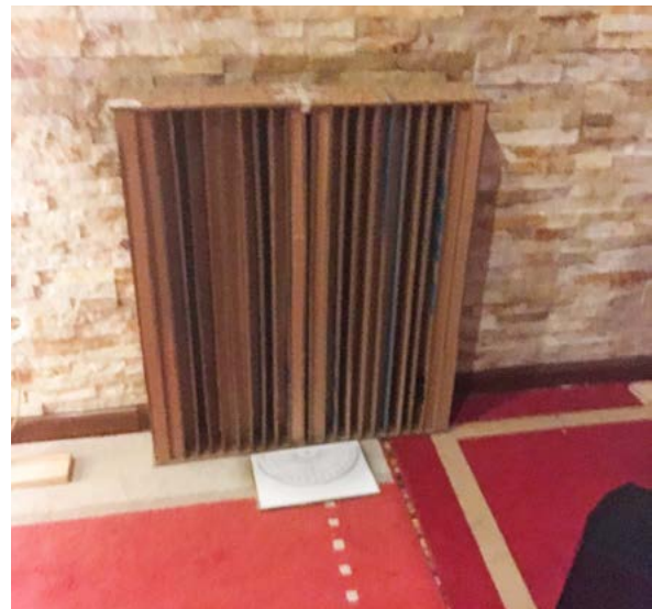
Figuras 2.9. Disposición de los elementos en la sala de grabación para el segundo ensayo. El semicírculo permite modificar la posición del micrófono receptor, de manera de controlar los grados a los que se encuentra, siempre a una distancia fija del difusor de 85 cm. El parlante no varía de posición y se encuentra también a 85 cm
