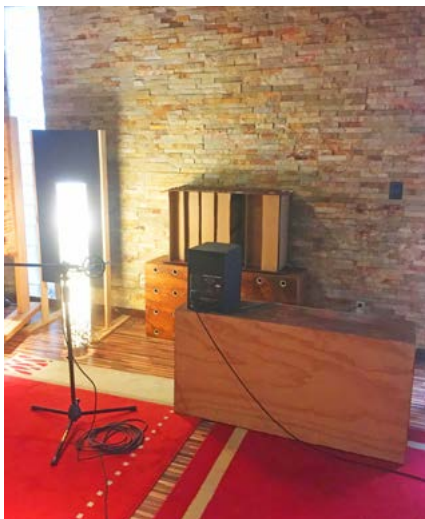
Figuras 2.7. Estudio de grabación con los materiales dispuestos para realizar la primera prueba. Difusor QRD 400 Hz dispuesto contra la pared a la altura de los paneles absorbentes. Por frente, a la misma altura, se encuentra el parlante que va a reproducir el sonido y un poco por detrás el micrófono que toma el sonido que rebota en el difusor. Por detrás de todos estos elementos se encuentran los paneles absorbentes que buscan eliminar sonidos ambientes que puedan intervenir en el sonido que reciba el micrófono, así como las alfombras en el suelo generan mayor absorción del sonido
