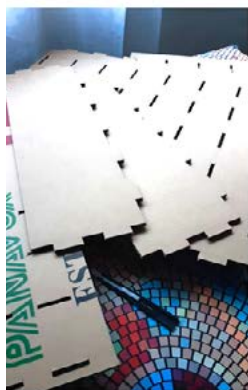
Figura 2.5. Construcción en cartón de los difusores. Cuentan con una base, una tapa de arriba y una tapa posterior. Luego las aletas (todas iguales) que definen cada ranura o celda, y su correspondiente tapa (varían la posición acorde a los cálculos realizados por el software QRDude
