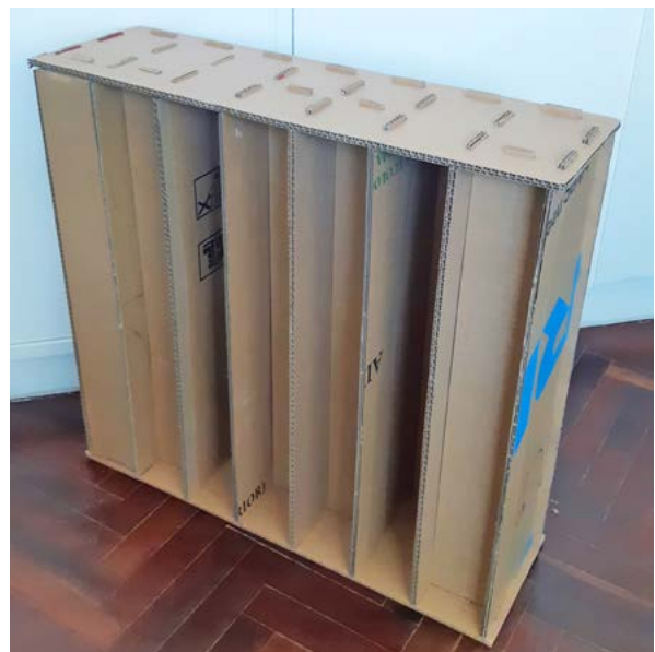
Figura 2.6. Difusores QRD contruidos por encastre. Modelo N7 y N11
