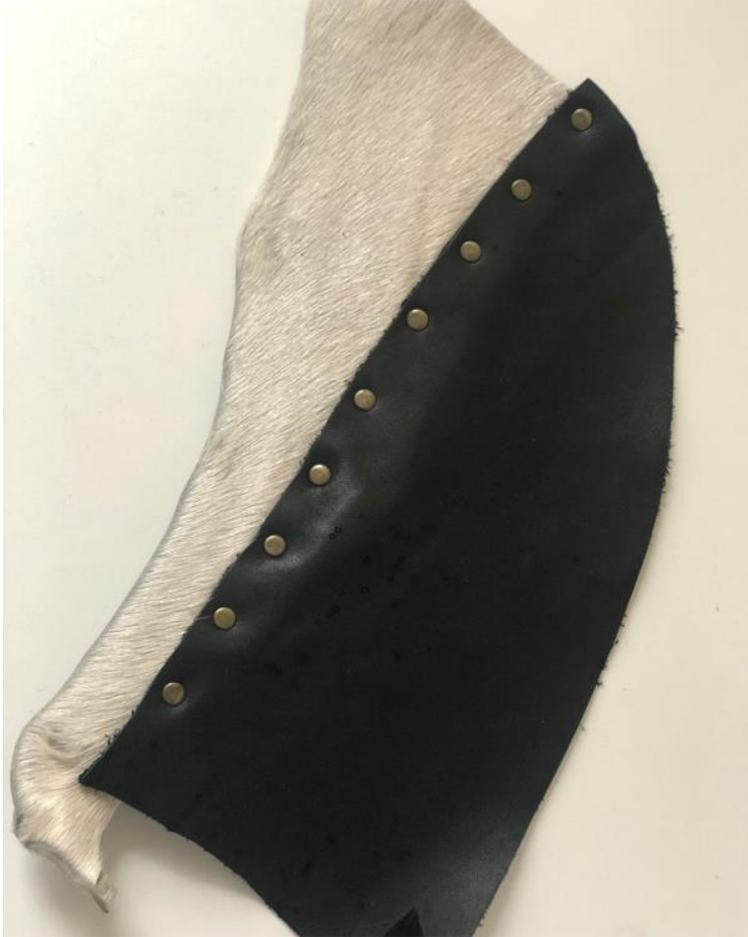
Pieza de cuero sin pelo posicionada por encima de pieza de cuero con pelo, unidas mediante avíos industriales: remaches.
