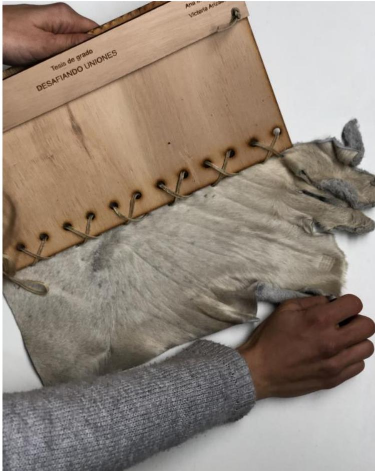
Placa de compensado y pieza de cuero de 15x30 cm perforados mediante corte láser y unidos con costura manual en zigzag con tiento de descarne.
