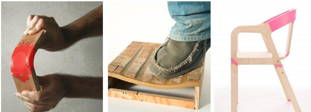
*Figura 46.* Muestra de flexibilidad de la articulación elástica
