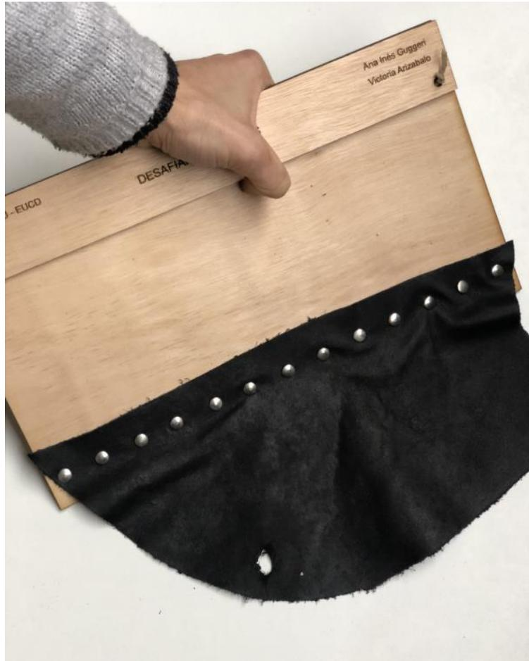
Cuero sin pelo superpuesto y unido con remaches sobre superficie de placa de madera.
