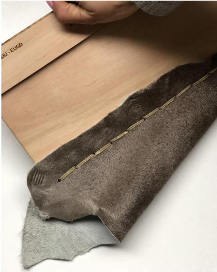
Placa de compensado y pieza de cuero de 15x30 cm perforados mediante corte láser y unidos mediante superposición con costura punto guarnicionero con tiento de lonja.
