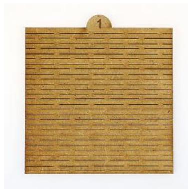
Figura 28. Corte de entalladura: Líneas de corte rectas
