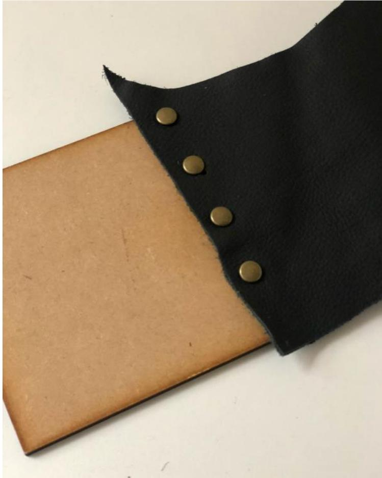
Cuadrado de MDF y pieza de cuero sin pelo perforados con sacabocados, superpuestos y unidos mediante remaches.
