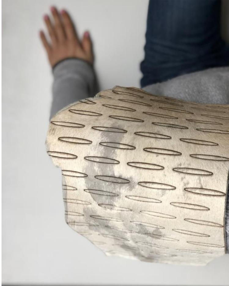
Grabado láser sobre superficie de cuero con pelo, sometido a una velocidad de 15 mm/s con una potencia de 45%.
