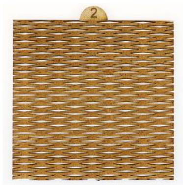
*Figura 29.* Corte de entalladura: Ondas pequeñas
