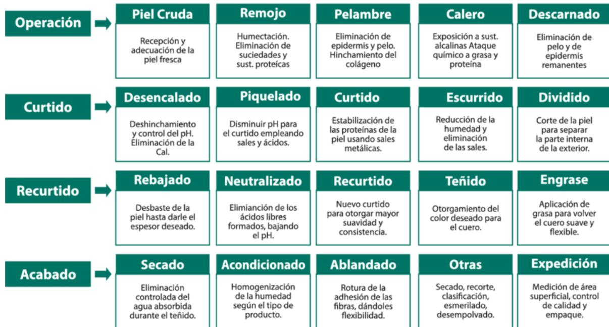
Figura 23. Flujograma del proceso de Curtido por Beghetto. (2003)
