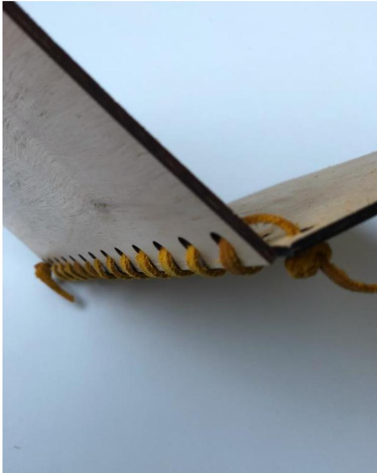
Placas de compensado de 15x30 cm, perforadas mediante corte láser y unidas mediante costura manual en zigzag con tiento de descarne.
