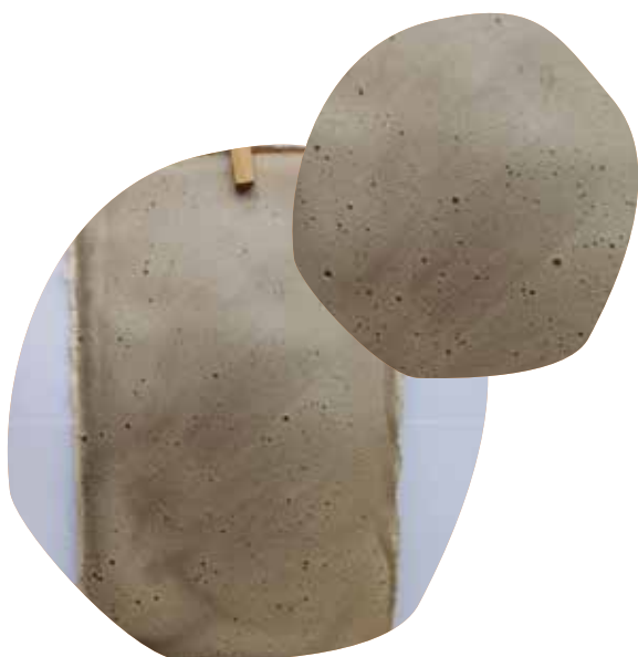
Figura 64 _ Muestra B3: Colorante de Santa Rita, mezcla batida. Cara superior
