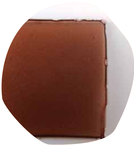
Figura 53 _ Muestra A4: Vertido y secado en molde de poliestireno expandido
