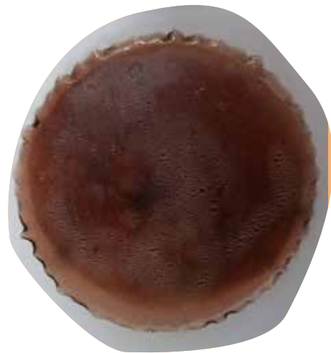
Figura 52 _ Muestra A4: Vertido y secado en molde de metal
