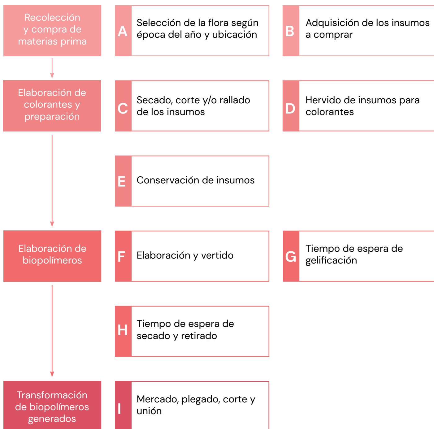
Figura 19 _ Desglose de las etapas del proceso de generación del biopolímero | Autoría propia
