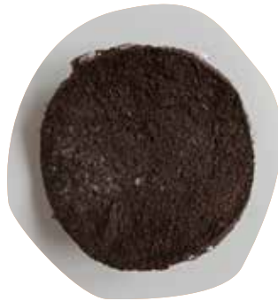
Figura 43 _ Muestra A22: Dos capas de vertido diferente color
