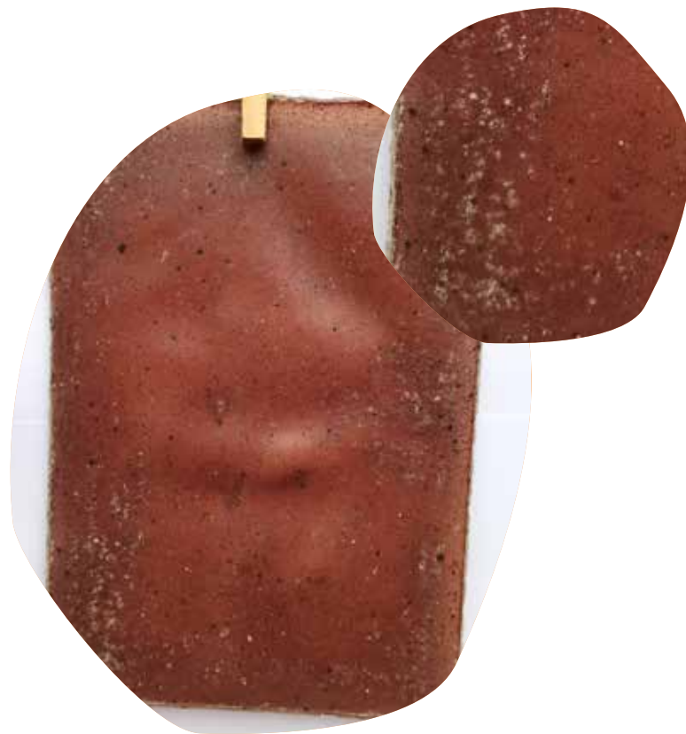
Figura 65 _ Muestra B12: Colorante de Santa Rita con aditivo de corteza de eucaliptus
