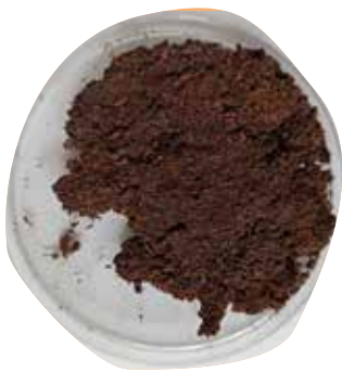
Figura 41 _ Muestra A7: Vertido en placa petri con aditivo de corteza de eucaliptus rallada
