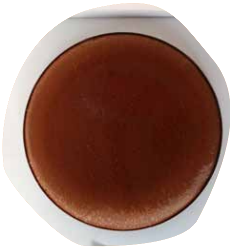
Figura 51 _ Muestra A1: Vertido y secado en placa petri
