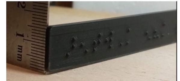
La tercera prueba consistió en mantener las características de la segunda exploración pero posicionar la pieza de manera vertical a la hora de imprimirla. Para que esto funcione es necesario que se imprima un borde ancho que auspicie de base y así evitar que la pieza se caiga. Este borde ha de ser removido manualmente e implica lijar los cantos para suavizarlos.
