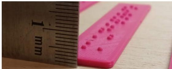
En la segunda exploración se mantuvo la condición de adhesión mediante pegado. El punto fue generado en el dibujo como media esfera. Para la impresión, la pieza se posicionó horizontalmente.
