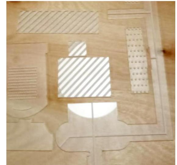
Se generan piezas en acrílico utilizando corte láser. Se ensaya la generación de texturas a través del grabado del material.
