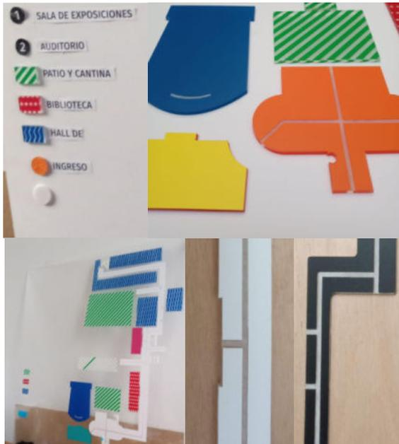
Pieza trayecto: Se prueban diferentes colores: blanco, negro y naranja. Se ensaya sobre cómo indicar el mostrador de atención. Se suavizan aristas utilizando un radio de 2 mm.
