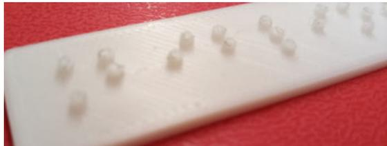
En una primera instancia se generaron piezas a ser pegadas al plano. El punto fue generado en el dibujo por extrusión de un cilindro. Para la impresión, la pieza se posicionó horizontalmente. Las esquinas fueron suavizadas manualmente con lija.
