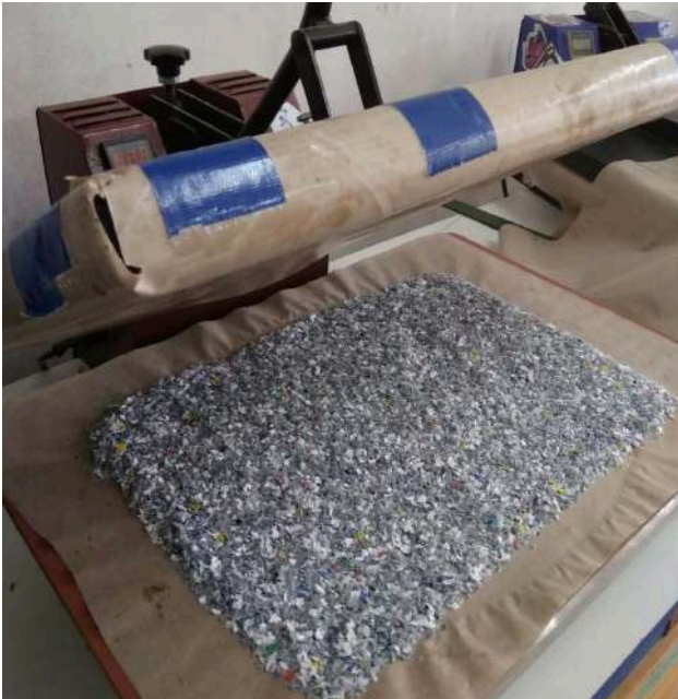
Imagen 13. Colocación de la molienda en plancha de serigrafía
