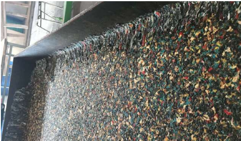
Imagen 9. Resultado del proceso de fusionas y enfriar el plástico.
