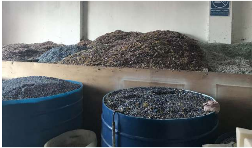
Imagen 5. Molienda plástica clasificada por el tipo de plástico.
