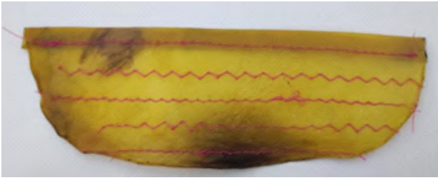
Figura 35: Prueba de costuras sobre celulosa bacteriana, lado derecho (fotografía de elaboración propia).
