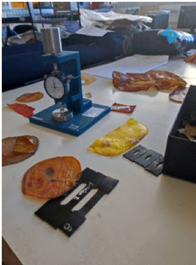
Figura 46: Instrumento para determinar el espesor en muestras (fotografía de autoría propia).
