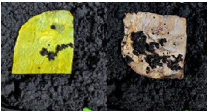
Figura 44: Muestras para ensayo de degradabilidad en tierra antes de ser colocadas en la misma (fotografía de autoría propia).
