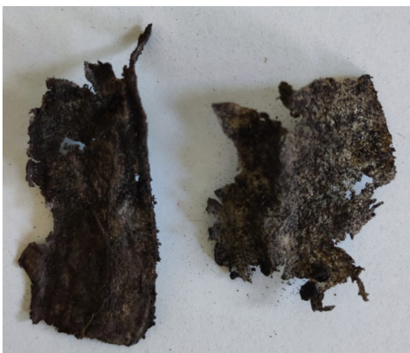
Figura 45: Muestras luego de estar en contacto con tierra durante dos meses (fotografía de autoría propia).
