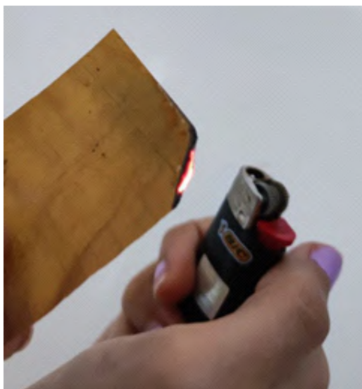
Figura 42: Muestra sometida a prueba de resistencia al fuego (fotografía de autoría propia).
