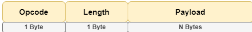
Figura 8.5: Diagrama que muestra la estructura de cada mensaje BLE recibido y transmitido en el sistema Cubinja.
