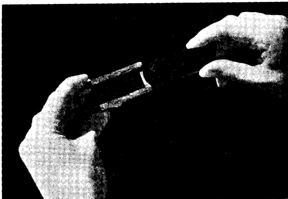
Figura N° 1. — La preparación es colocada en las guías especiales para ser observada en el lanómetro.
