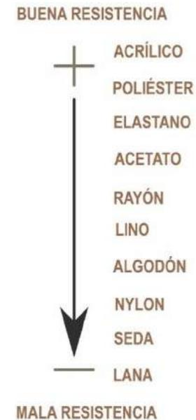
Figura 6. Resistencia a la luz solar. Reproducido de Hollen y Saddler (2002)
