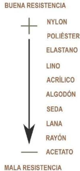
Figura 5. Resistencia a la abrasión. Reproducido de Hollen y Saddler (2002)
