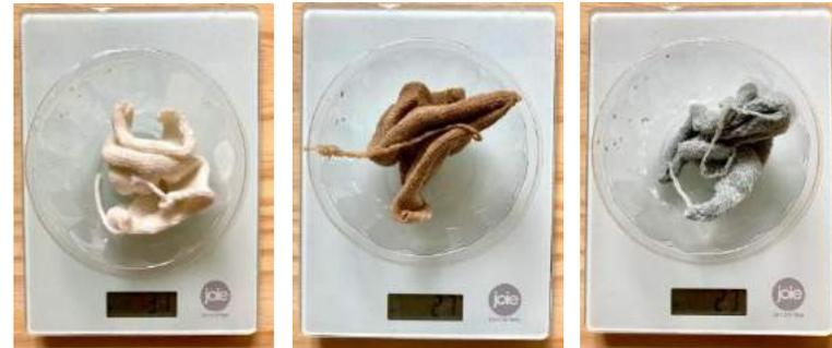
4. Se dejaron secar al sol controlando la temperatura y humedad en el ambiente y se calculó el tiempo de secado. Las temperaturas variaron entre los 23 °C y 27 °C con una humedad de entre 30 % y 50 %.
