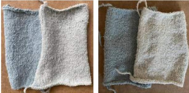
Para la prueba de la resistencia a la luz solar no se observó ningún cambio en el color de la muestra expuesta por más de 24 horas a la luz solar.
