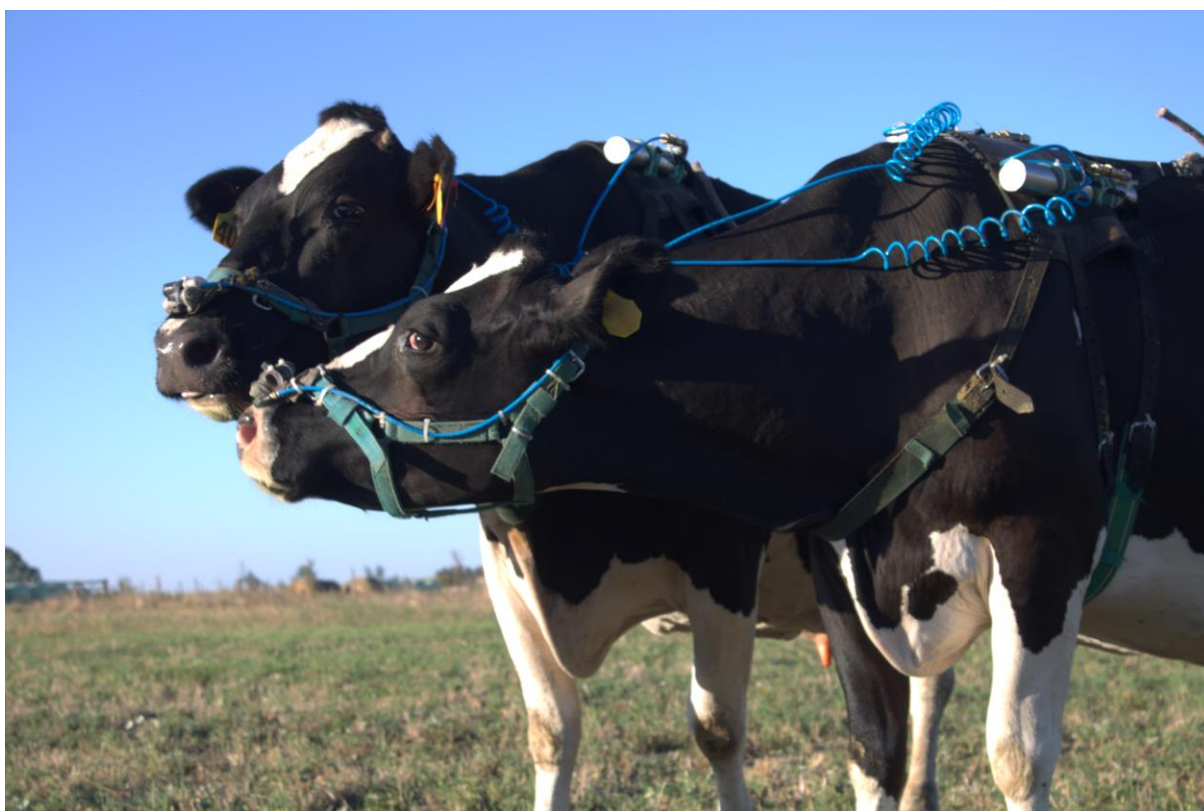
Figura 1: Vacas con dispositivos recolectores de metano
