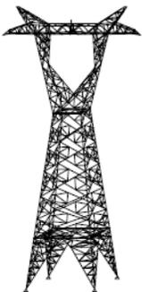
Fig. 2. Esquema típico de torre 500 kV
